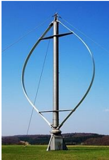
Εικόνα 1-1 Ανεμογεννήτρια κατακόρυφου άξονα
