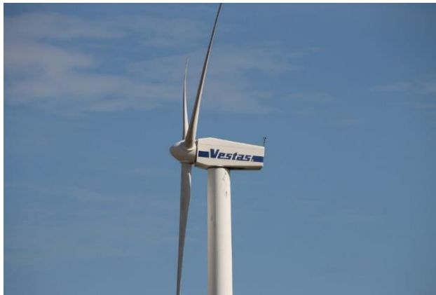
Εικόνα 4-6 Vestas V42 600kW
