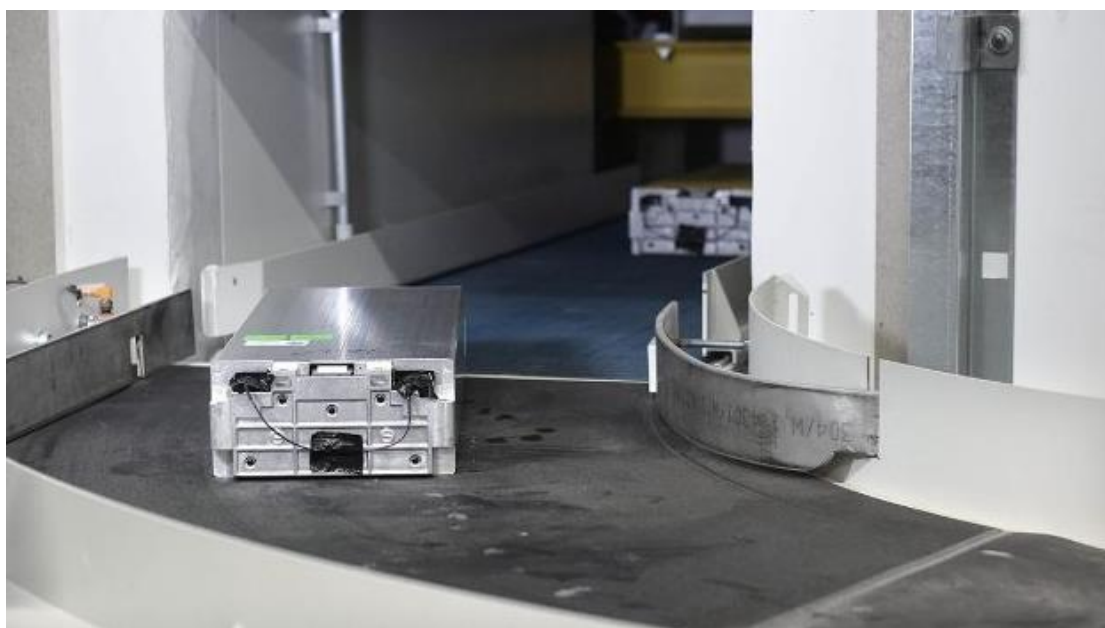
Εικόνα 4.27: Μεταφορά συστοιχίας μέσω μεταφορικής ταινίας. Η εικόνα προέρχεται από το πιλοτικό πρόγραμμα ανακύκλωσης της Volkswagen. (Τα πνευματικά δικαιώματα ανήκουν αποκλειστικά στην Volkswagen.) Πηγή: Volkswagen [141]
