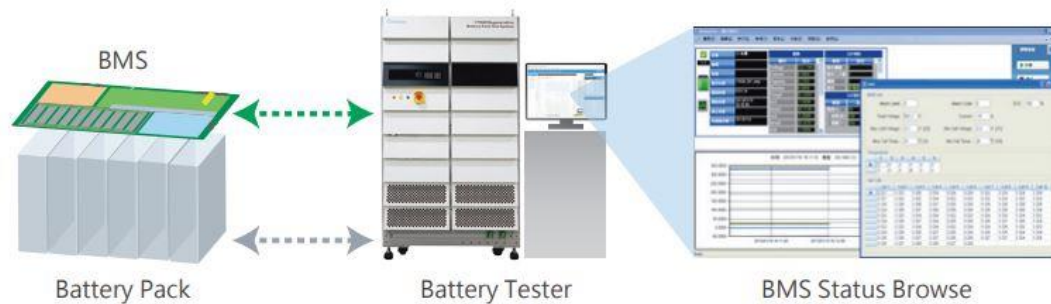
Εικόνα 4.19: Σύνδεση διαγνωστικού μηχανήματος με το BMS. Πηγή: Chroma [101]
