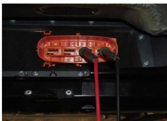
Εικόνα 4.21: Μέτρηση τάσης του συσσωρευτή πριν αυτός αποσυναρμολογηθεί. Πηγή: Science Direct [125].
