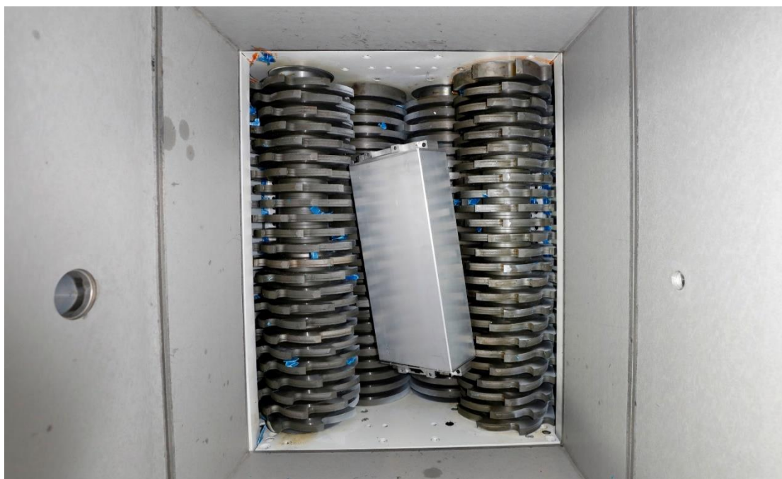
Εικόνα 4.28: Συστοιχία συσσωρευτή στον κονιορτοποιητή. Η εικόνα προέρχεται από το πιλοτικό πρόγραμμα ανακύκλωσης της Volkswagen. (Τα πνευματικά δικαιώματα ανήκουν αποκλειστικά στην Volkswagen.) Πηγή: Volkswagen [141]
