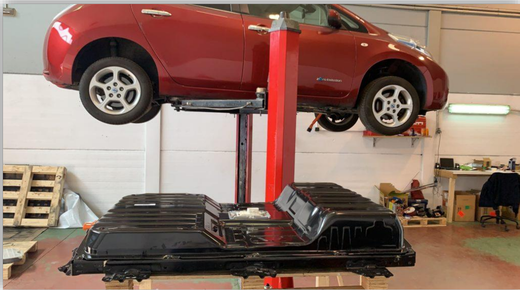
Εικόνα 4.20: Αφαίρεση στον συσσωρευτή από το ηλεκτρικό όχημα Nissan Leaf. Πηγή: EV battery rebuilds [126]
