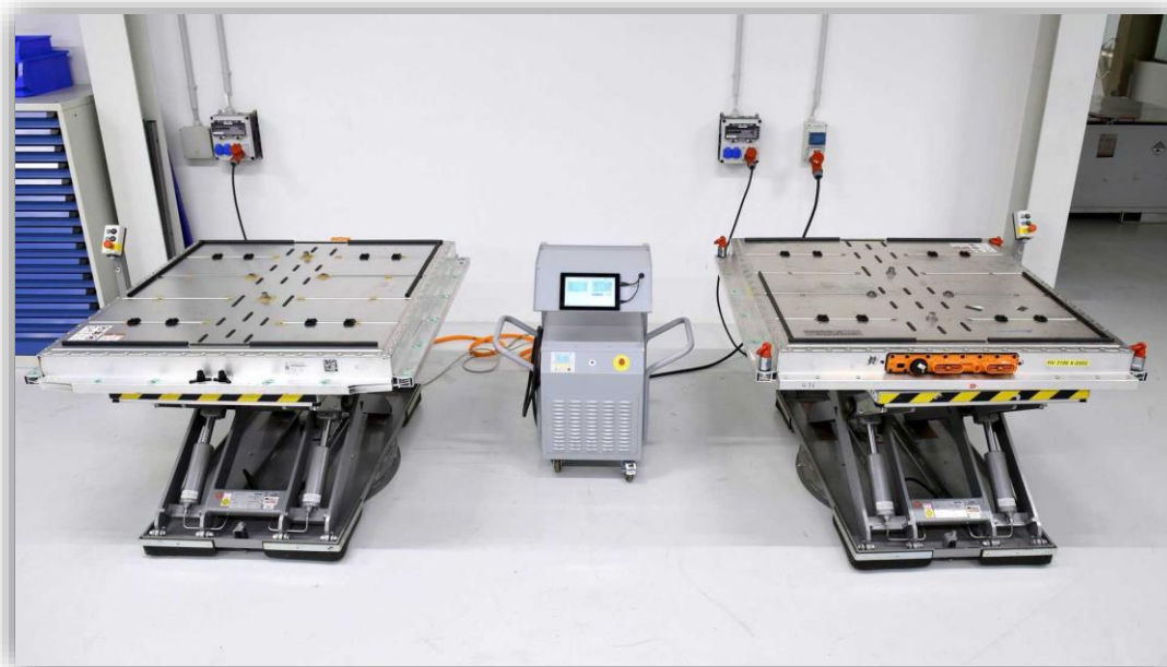
Εικόνα 4.22: Διάγνωση και αξιολόγηση του συσσωρευτή. Η εικόνα προέρχεται από το VW recycling plant. (Τα πνευματικά δικαιώματα ανήκουν αποκλειστικά στη VW). Πηγή: VW [28],[119]
