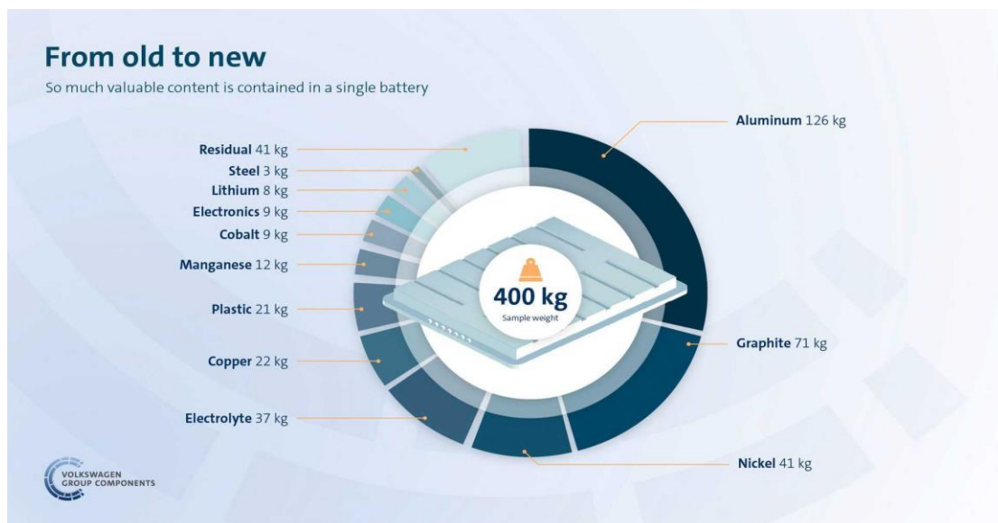
Εικόνα 4.18: Αναλυτικά τα στοιχεία κατά βάρος σε έναν συσσωρευτή. (Τα πνευματικά δικαιώματα ανήκουν αποκλειστικά στο Volkswagen Group.) Πηγή: Volkswagen [28],[119]
