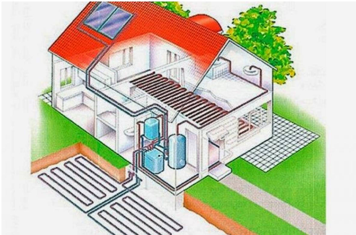
Εικόνα 18 . Γεωθερμική αντλία θερμότητας
