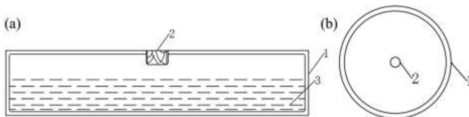
Σχήμα 12. Η κατασκευή του δείκτη θερμοκρασίας χρόνου. (a) πλάγια όψη (b) πρόσοψη του. 1 – το διαφανές δοχείο σε σχήμα δίσκου, 2 – το ελαστικό πώμα, 3 – το μείγμα ένδειξης pH, υποστρώματος θρεπτικών συστατικών και μικροβίων
