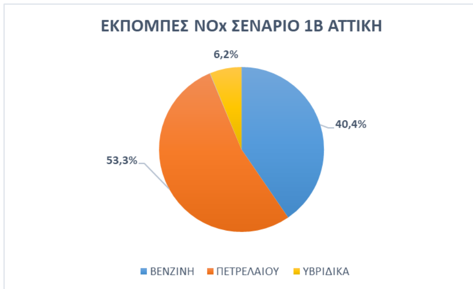
Γράφημα 6.26 : Το μερίδιο συνεισφοράς των επιβατικών ανά καύσιμο στις εκπομπές NO x στην Αττική το 2030, Σενάριο 1B.
