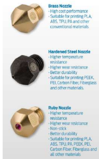
Εικόνα 3.3.2 Τα διαφορετικά είδη θερμαινόμενων ακροφυσίων
