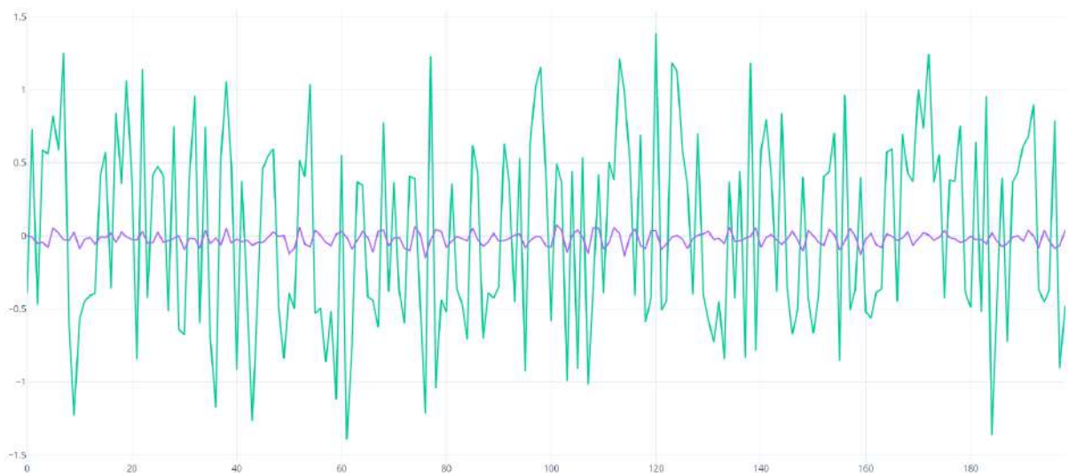
Εικόνα 6.2.3 Σύγκριση κανονικής(μωβ) και ανώμαλης(πρασινη) κυματομορφής λειτουργίας για τον άξονα Y
