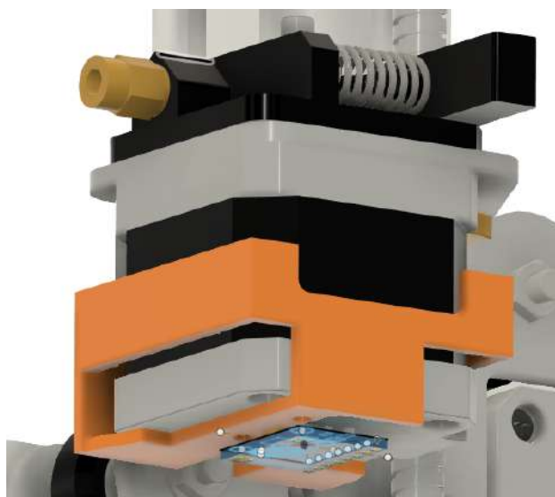
Εικόνα 5.2.4 Τρισδιάστατη απεικόνιση εφαρμογής της βάσης του επιταχυνσιομετρου MPU-6050
