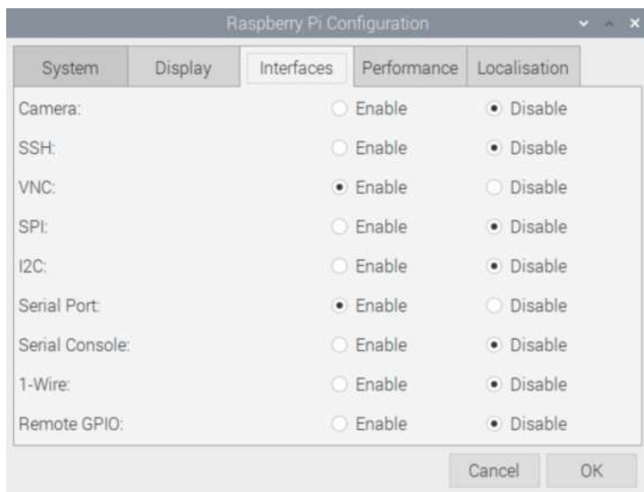
Εικόνα 7.2.6 Ενεργοποίηση σειριακής λειτουργίας μέσω του Raspberry Pi configuration tab
