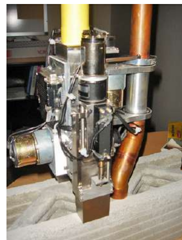
Εικόνα 1.3.7 Ακροφύσιο εναπόθεσης υγρού σκυροδέματος
