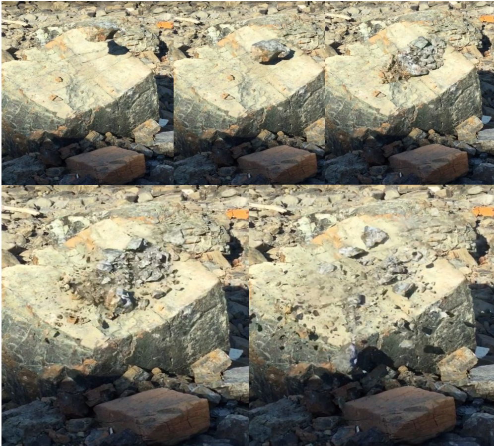
Εικόνα (7.8) Θραύση τεμάχους σε πέντε στάδια. (α) Κατάπτωση (β) Πρόσκρουση με επιφάνεια (γ) θραύση τεμάχους σε κομμάτια (δ,ε) εκτόξευση θραυόμενων τεμαχίων (Πήλιο Ευβοίας) (Προσωπικό αρχείο)
