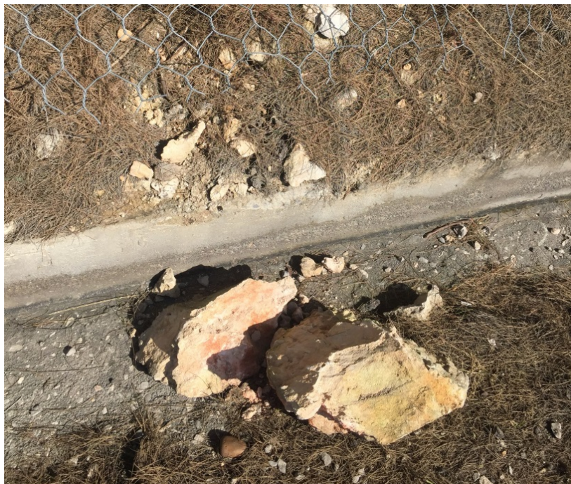
Εικόνα (4.10) Θραυσμένο τεμάχος σε δύο κύρια κομμάτια (Μαλακάσα) (Προσωπικό αρχείο)
