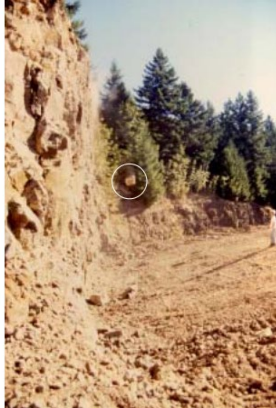
Εικόνα (3.8) Επιτόπου δοκιμές κατάπτωσης βράχων (Oregon.gov/ODOT)
