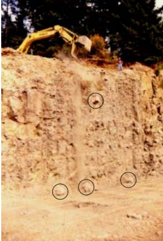
Εικόνα (3.8) Επιτόπου δοκιμές κατάπτωσης βράχων (Oregon.gov/ODOT)
