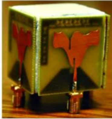
Σχ 31. Κατασκευασμένο 3D σύστημα MIMO κεραίας [33].
