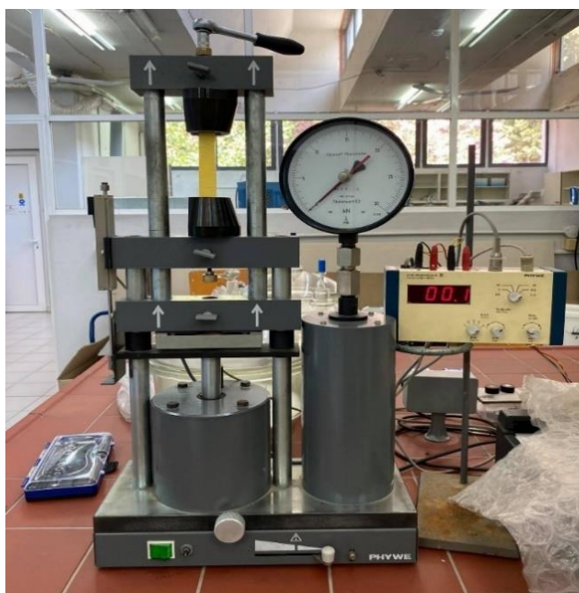
Εικόνα 3.6 Απεικόνιση διάταξης της δοκιμασίας ελέγχου σε εφελκυσμό που χρησιμοποιήθηκε στα πλαίσια του πειράματος.
