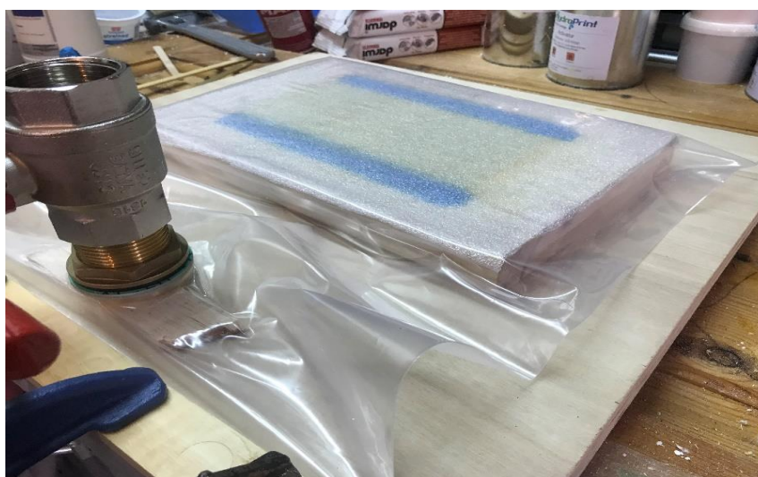
Εικόνα 3.3 Απεικόνιση της διαδικασίας κατασκευής της αρχικής πλάκας του σύνθετου, με τη μέθοδο σάκου κενού ( Vacuum bag ).
