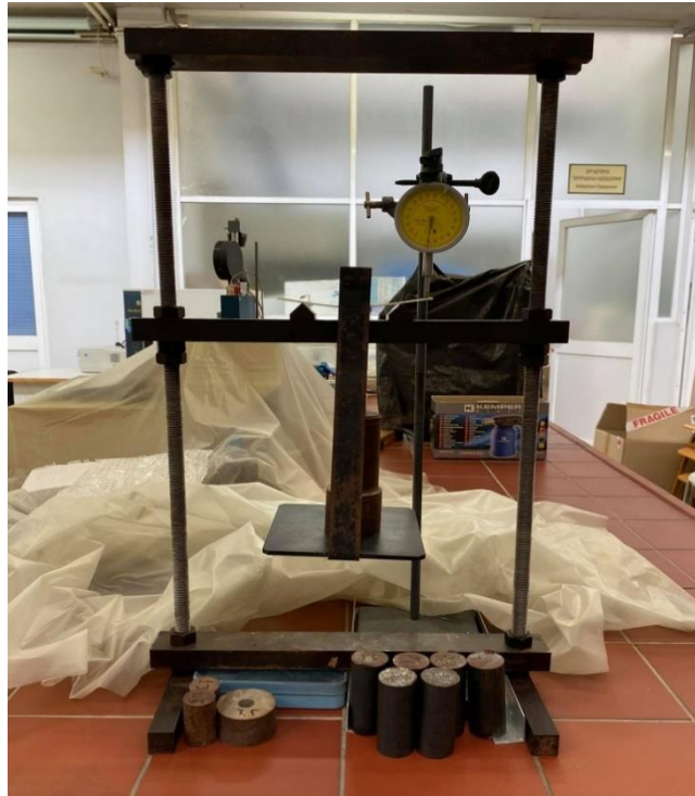
Εικόνα 3.7 Απεικόνιση διάταξης της δοκιμασίας ελέγχου σε κάμψη που χρησιμοποιήθηκε στα πλαίσια του πειράματος.
