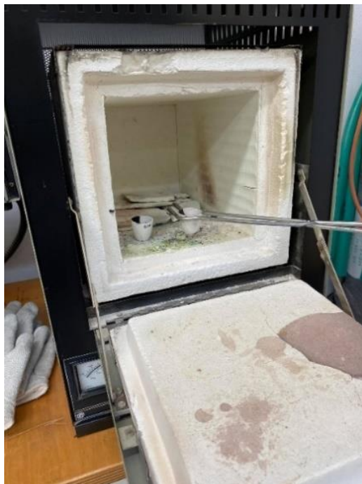
Εικόνα 3.9 Απεικόνιση διάταξης ελέγχου σε καύση που χρησιμοποιήθηκε στα πλαίσια του πειράματος.
