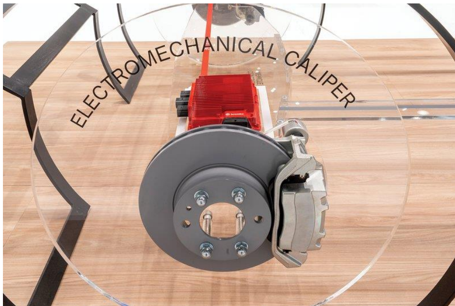
Εικόνα 97: Σύστημα Πέδησης “Break-By-Wire” της Brembo [97]
