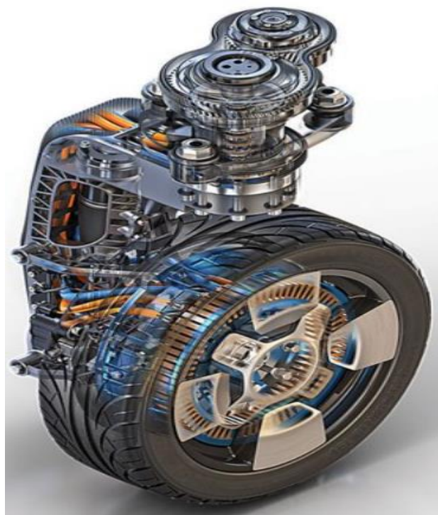
Εικόνα 98: Ηλεκτροκινητήρας τοποθετημένος έκκεντρα στον άξονα του οχήματος, ενσωματωμένος στον τροχό [97]
