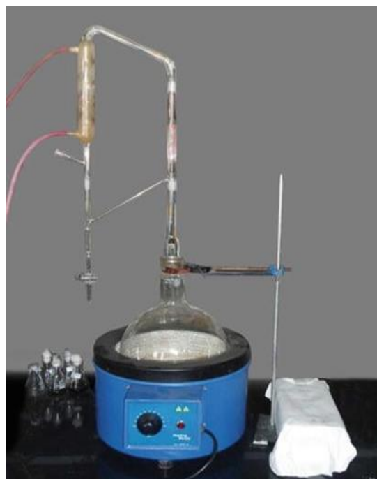
Εικόνα 16 Συσκευή Clevenger που χρησιμοποιείται στη μέθοδο υδροπόσταξης
