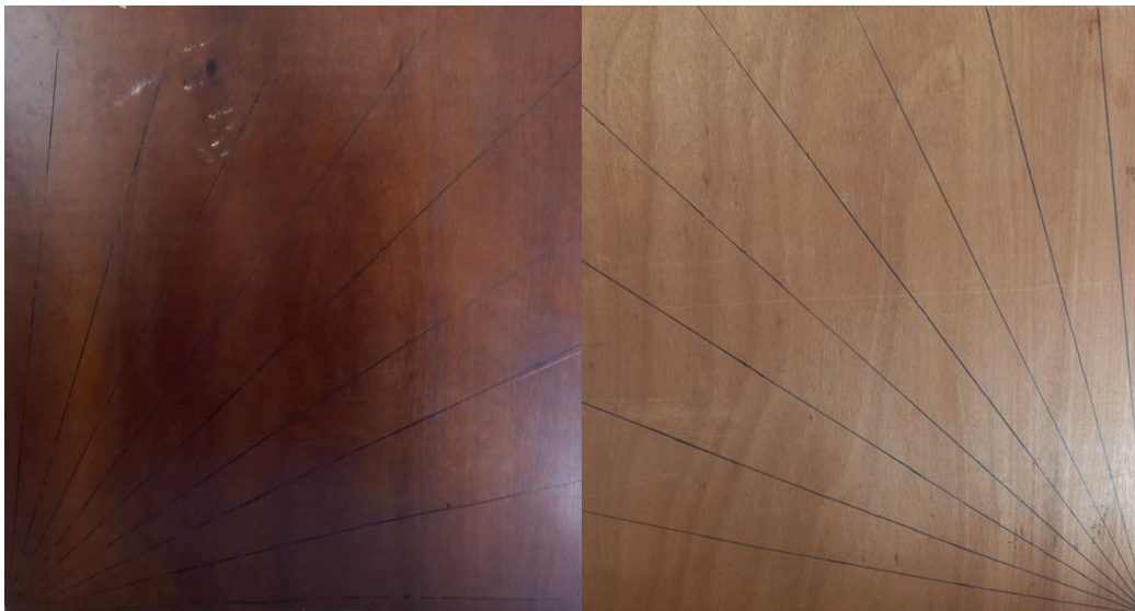
Εικόνα 3.1: Κατασκευή για τη διεξαγωγή του Lord test. Τεμάχιο ξύλου, με διαστάσεις 100 εκατοστά ύψος και 80 εκατοστά μήκος διαβαθμισμένο σε μοίρες (0-90°) και στις δύο επιφάνειές του.
