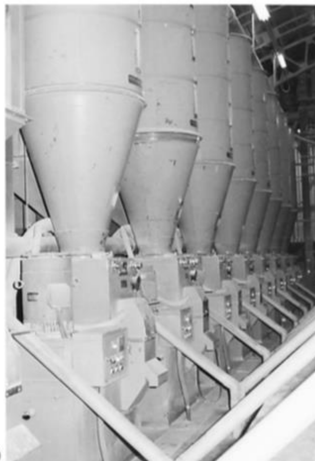
Εικ. 2.4 Βιομηχανικός μύλος κάθετου τύπου (φωτογραφία) (Yoshizawa 2004a)
