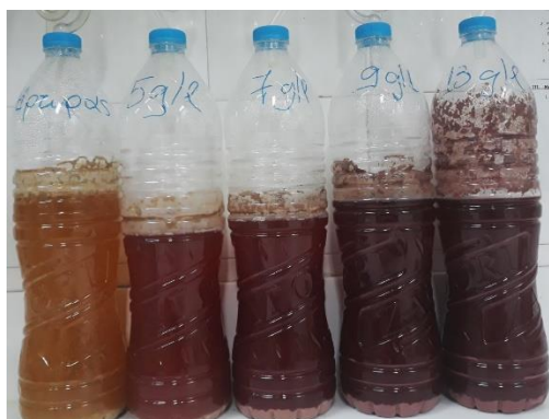
Εικόνα 5.8 Πειραματική αλκοολική ζύμωση ζυθογλευκών μάρτυρα και συγκεντρώσεων 5, 7, 9 και 13 gr/l
