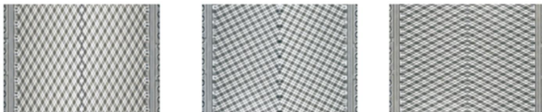
Εικόνα 2.2: Απεικόνιση τύπων καναλιών L (αριστερά), M (στη μέση) και H (δεξιά). (Alfa Laval, 2018)
