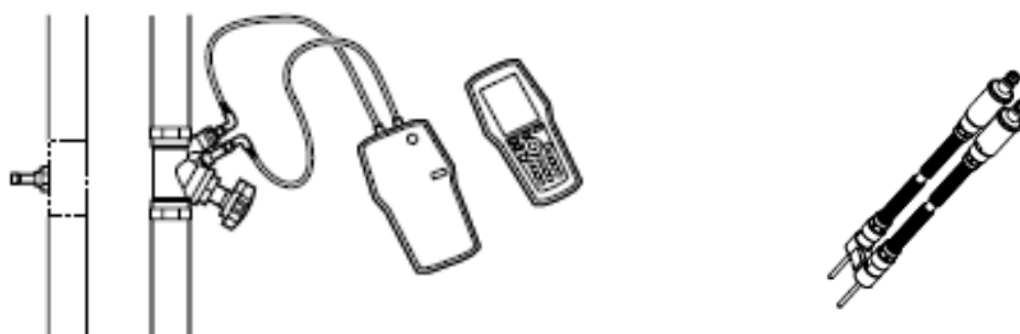
Εικόνα 7.8 Συνδεσμολογία οργάνου με βαλβίδα στραγγαλισμού STAD και σωλήνες μέτρησης με διπλή βελόνα 150 mm
