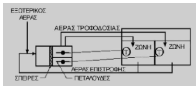
Σχήμα 3.4.5. Σύστημα πολλαπλών ζωνών
