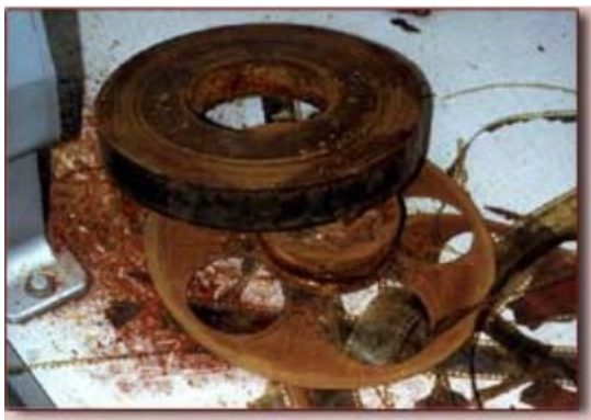
Εικόνα 38. Φιλμ νιτρικής κυτταρίνης σε πλήρη αποσύνθεση (αριστερά) και σε ανάφλεξη (δεξιά)
