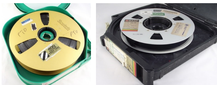
Εικόνα 14. Μαγνητική βιντεοταινία ανοικτής μπομπίνας, Quadruplex (2-inch Quad) (1956-αρχές δεκαετία 1980) (αριστερά), 1-inch Type B (1975-δεκαετίας 1980) (δεξιά)
