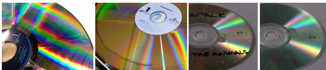
Εικόνα 59. Φθορές σε LaserDisc (LD) και Compact Disc (CD) (από αριστερά προς δεξιά)
