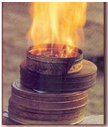
Εικόνα 38. Φιλμ νιτρικής κυτταρίνης σε πλήρη αποσύνθεση (αριστερά) και σε ανάφλεξη (δεξιά)
