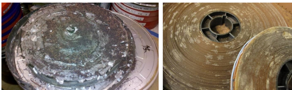
Εικόνα 35. Αποσύνθεση (αριστερά), Μύκητες/ μούχλα (δεξιά)
