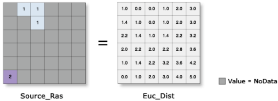
Σχήμα 20 Τρόπος λειτουργίας του εργαλείου Euclidean Distance (Πηγή: ESRI) Στον παρακάτω χάρτη απεικονίζεται η ευκλείδεια απόσταση από το υδρογραφικό δίκτυο στην περιοχή μελέτης.
