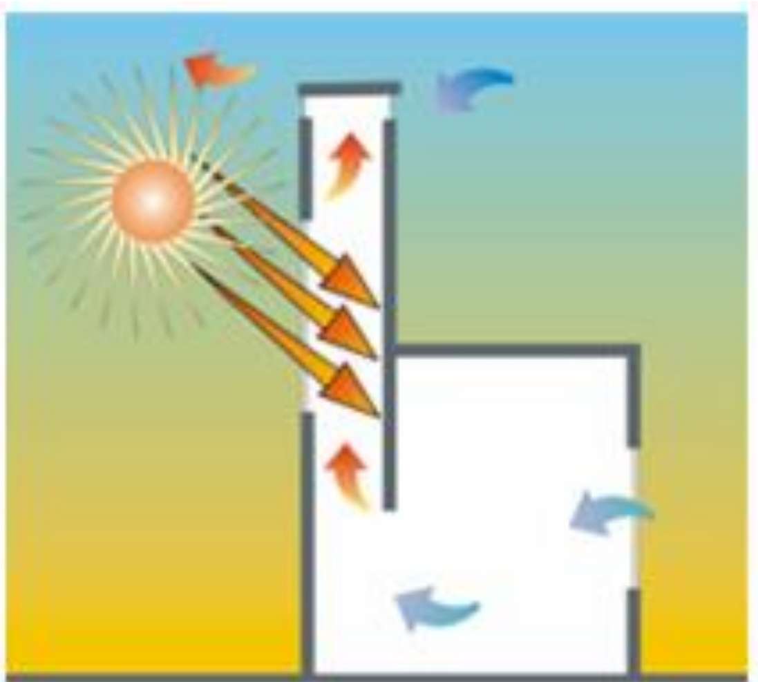
Εικόνα 16: Σχεδιάγραμμα λειτουργίας ηλιακής καμινάδας. Πηγή: http://www.cres.gr/energy_saving/Ktiria/fysikos_drosismos_fysikos_aerismos.htm
