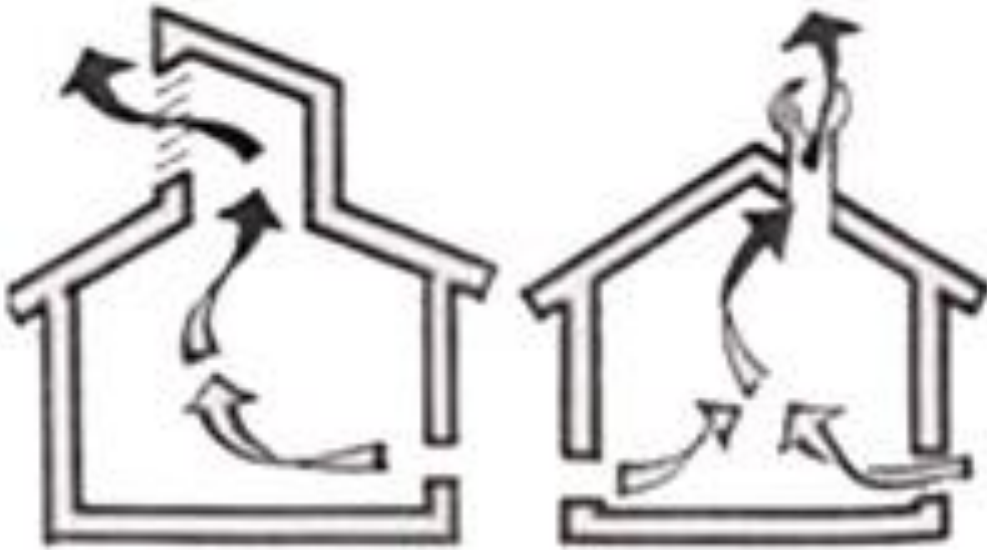
Εικόνα 14: Σχεδιάγραμμα λειτουργίας καμινάδας αερισμού. Πηγή: http://www.cres.gr/energy_saving/Ktiria/fysikos_drosismos_fysikos_aerismos.htm
