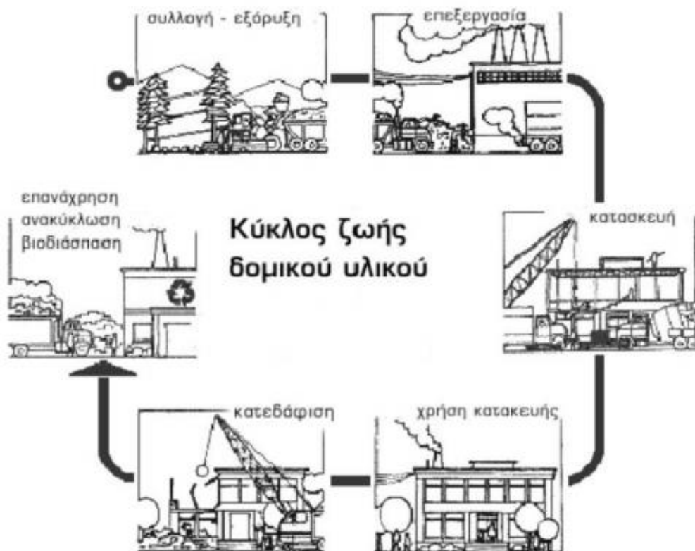
Εικόνα 25: Κύκλος ζωής του δομικού υλικού. Πηγή: Κορωναίος Γ.Αιμ., 2005, Δομικά Υλικά και Οικολογία 2
