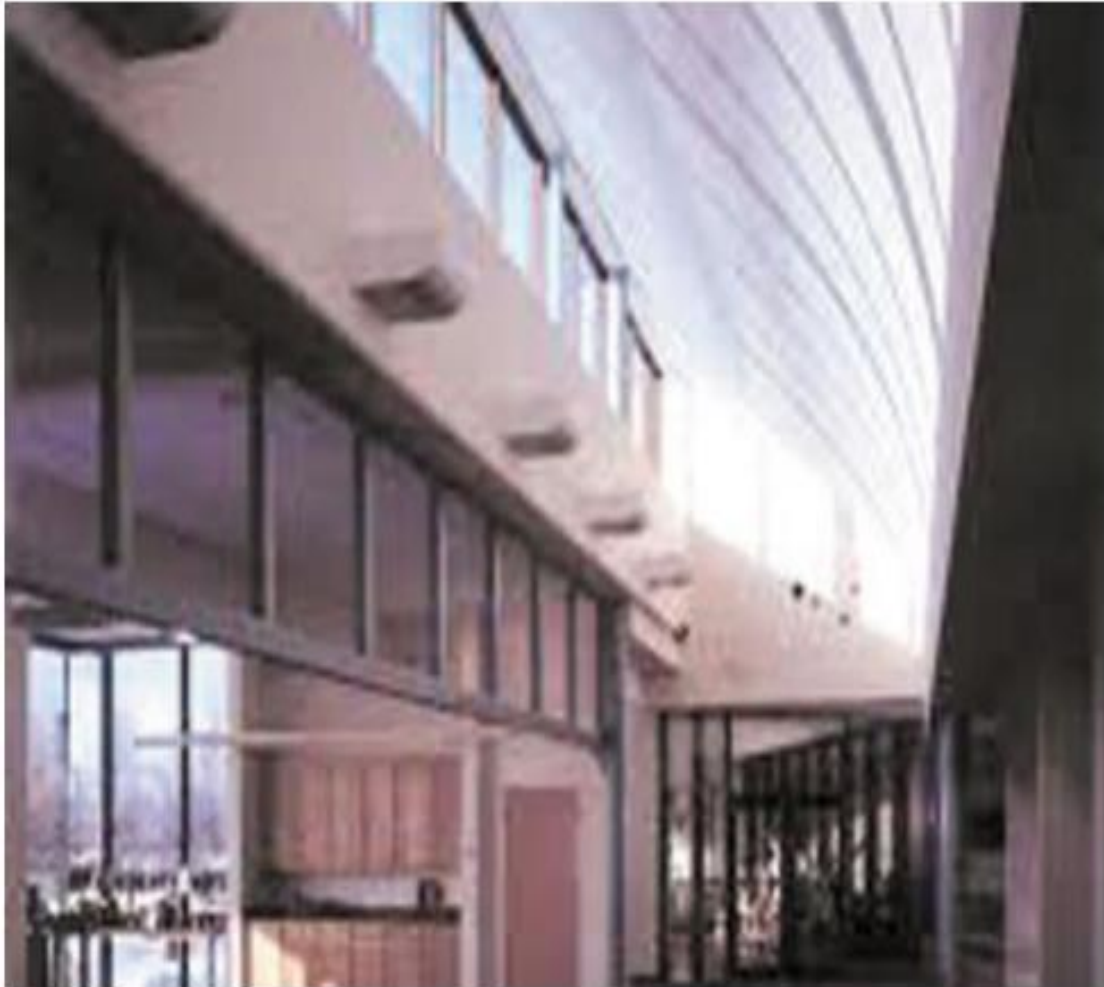
Εικόνα 19: Φυσικός φωτισμός σε κοινόχρηστο χώρο με χρήση αιθρίου. Πηγή: Το Σπίτι του Μέλλοντος Ελένη Βασιλικού Ιωάννα Κάγια, Αθήνα 2013 6
