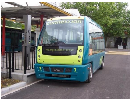
Εικόνα 1.3: Το αυτόνομο ηλεκτρικό όχημα μαζικής μεταφοράς ParkShuttle [6].
