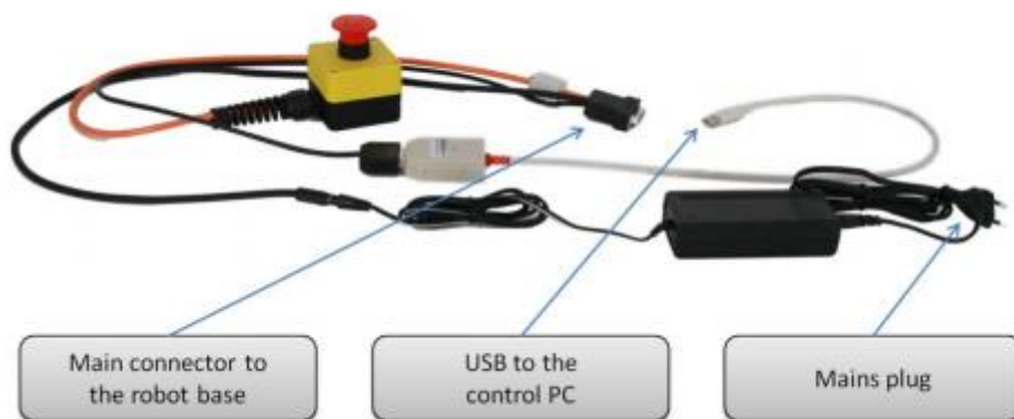
Εικόνα 21 - Καλωδίωση ρομποτικού συστήματος
