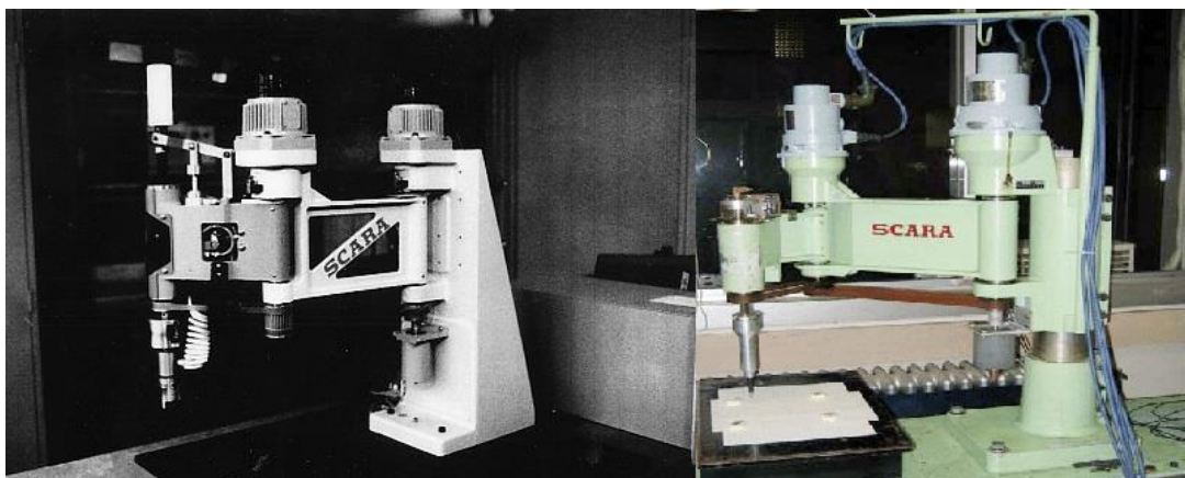
Εικόνα 5 - Δύο πρωτότυπα ρομποτικά συστήματα τύπου SCARA του καθηγητή Hiroshi Makino
