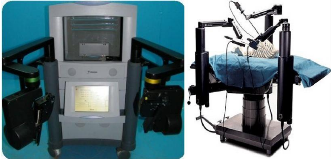
Εικόνα 13 - Σύστημα ZEUS της Computer Motion: Χειρισμός διαδικασίας από τον χειρουργό (αριστερή διάταξη) , ρομποτικοί βραχίονες (δεξιά διάταξη)
