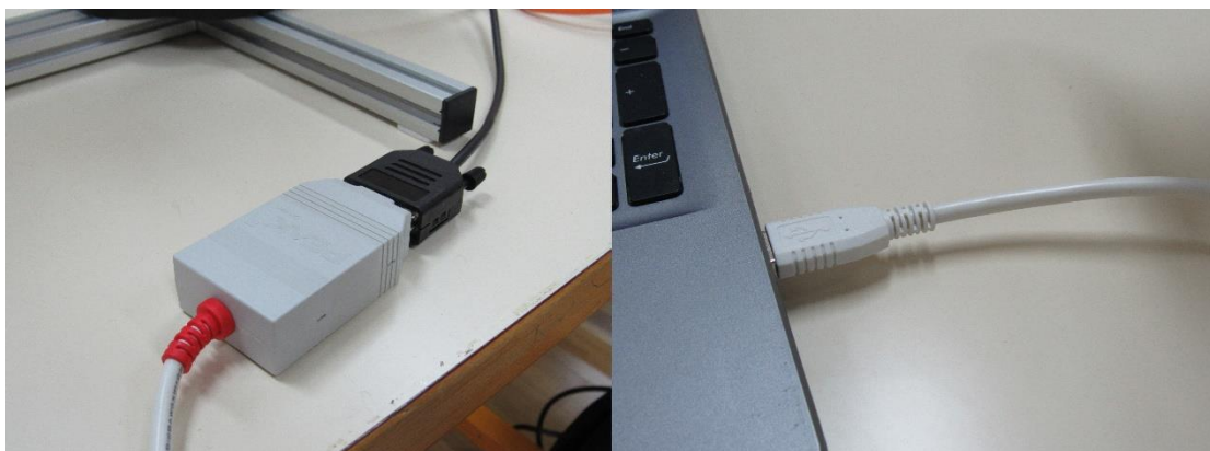
Εικόνα 26 - Σύνδεση ειδικού μετατροπέα με το ρομποτικό σύστημα (αριστερά) και σύνδεση με USB θύρα στον υπολογιστή (Δεξιά)
