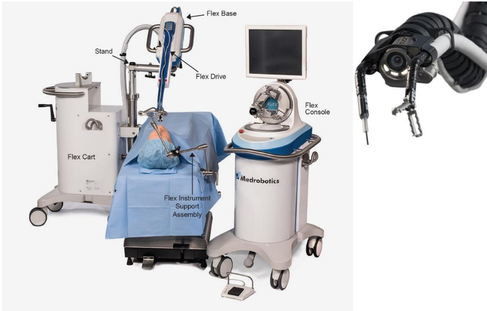
Εικόνα 16 - Flex Robot System by Medrobotics (Αριστερά: η ολική διάταξη του ρομποτικού συστήματος, Δεξιά: Ο πολυαρθρωτός σωλήνας εισχώρησης στον ασθενή)
