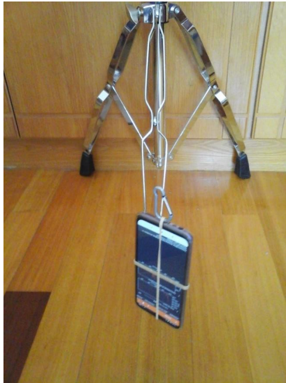
Εικόνα 3.10: Τοποθέτηση κινητού τηλεφώνου στο άκρο του νήματος
