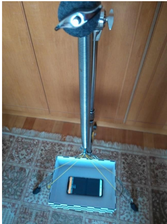
Εικόνα 5.4: Τελική πειραματική διάταξη μέτρησης σταθεράς ελατηρίου
