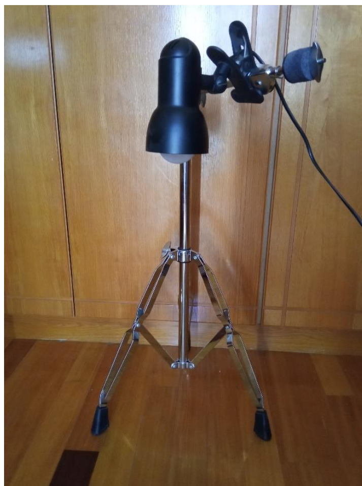
Εικόνα 11.3: Πρόσδεση φωτεινής πηγής
