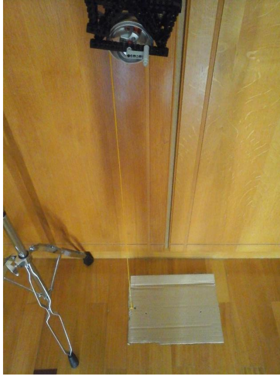
Εικόνα 9.5: Τελική πειραματική διάταξη υπολογισμού στατικής τριβής
