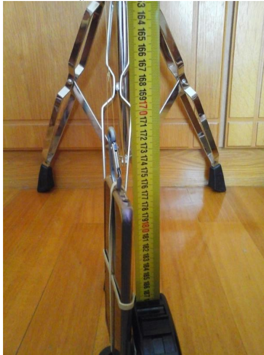
Εικόνα 3.12: Μέτρηση μήκους νήματος εκκρεμούς
