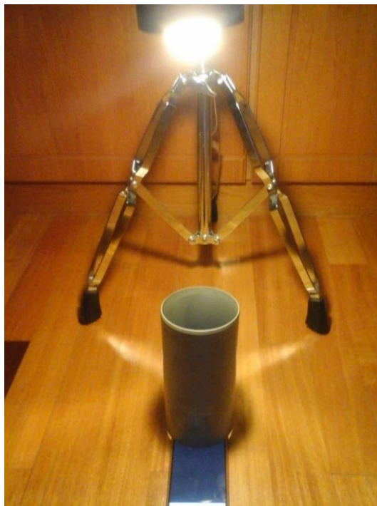
Εικόνα 11.7: Πρώτη μέτρηση πειράματος έντασης φωτός συναρτήσει απόστασης
