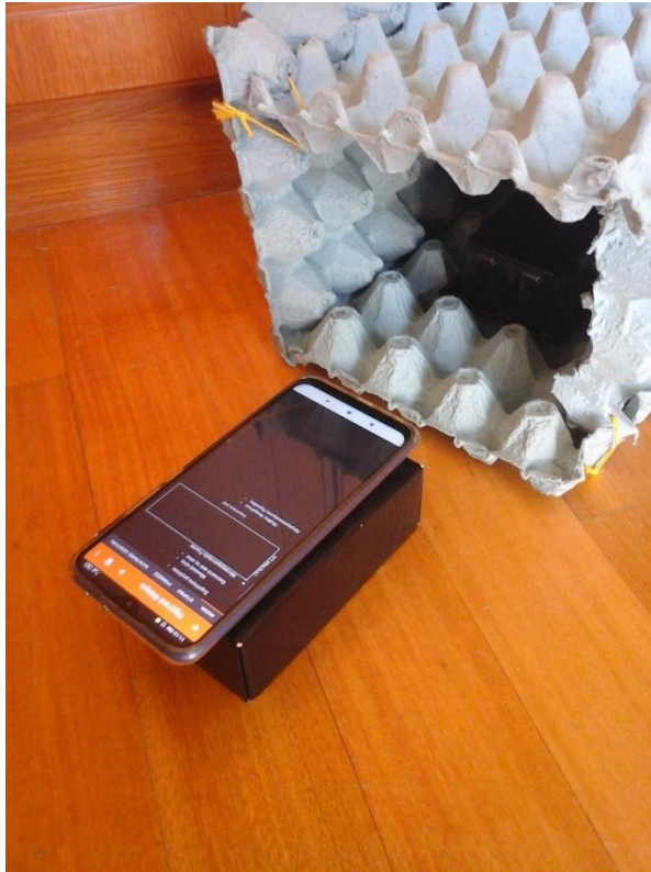
Εικόνα 4.5: Τελική πειραματική διάταξη μέτρησης ταχύτητας ήχου
