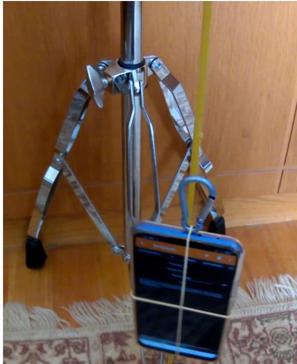
Εικόνα 3.4: Τελική πειραματική διάταξη εκκρεμούς
