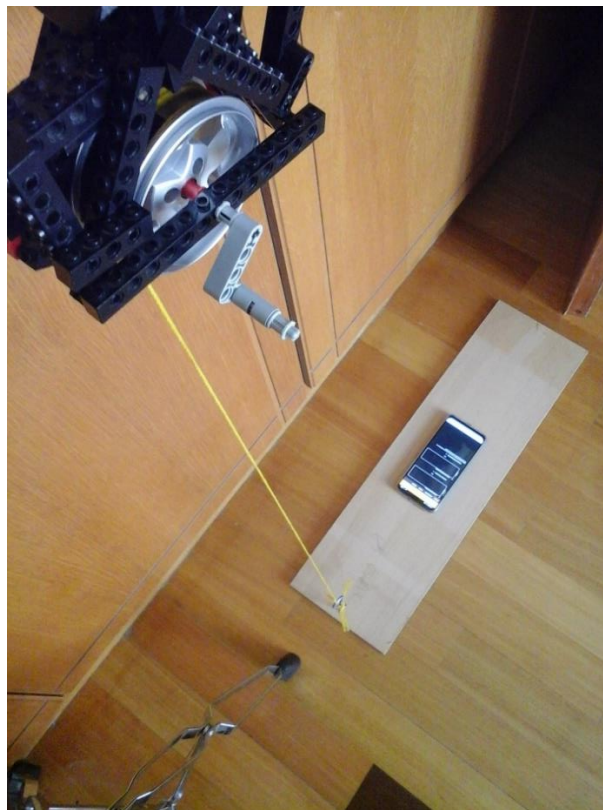
Εικόνα 9.8: Τελική πειραματική διάταξη εύρεσης στατικής τριβής για τη δεύτερη επιφάνεια
