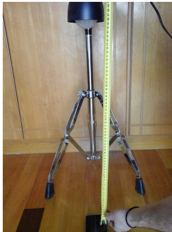
Εικόνα 11.5: Μέτρηση κατακόρυφης απόστασης φωτεινής πηγής – κινητού τηλεφώνου
