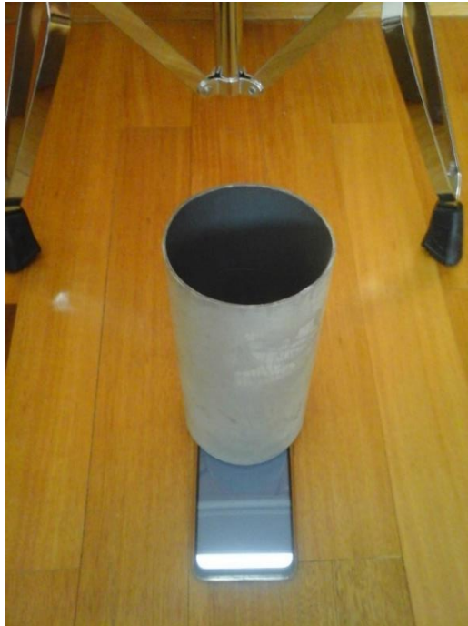
Εικόνα 11.6: Τελική πειραματική διάταξη έντασης φωτός, συναρτήσει απόστασης
