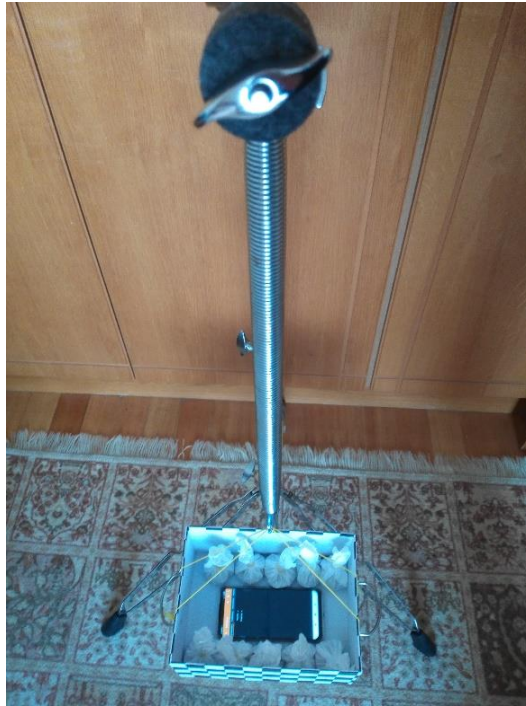
Εικόνα 5.5: Τοποθέτηση μαζών στην επίπεδη επιφάνεια
