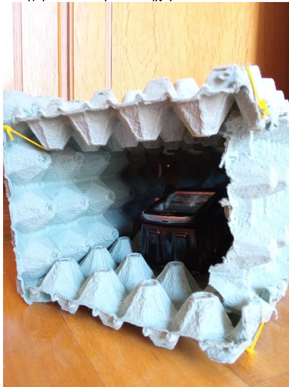
Εικόνα 4.4: Τοποθέτηση κινητού τηλεφώνου μέσα στο ηχομονωτικό κουτί
