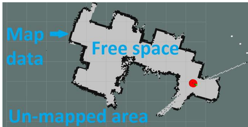
Εικόνα 2. 13: Σύνθετος χάρτης, με γκρι χρώμα είναι ο ελεύθερος χώρος (free space map), με μαύρο τα αντικείμενα εμπόδια (object map) [34].
