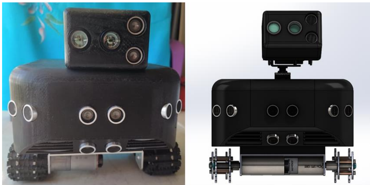
Εικόνα 3. 1: Ρομποτικό Σύστημα Διπλωματικής. Αριστερά η κατασκευή, δεξιά σε 3D απεικόνιση.
