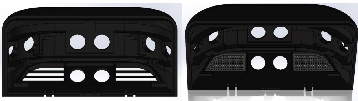
Εικόνα 3. 8: Μπροστινό καπάκι. Αριστερά χωρίς πλέγμα, δεξιά με πλέγμα.
