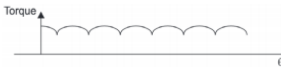
Εικόνα 5.10: Κυμάτωση της ροπής λόγω τραπεζοειδούς ελέγχου (Kiran, 2014)
