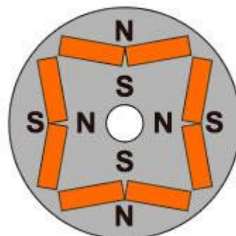
Εικόνα 4.2: Κινητήρας MM εσωτερικών μαγνητών (Levkin)
