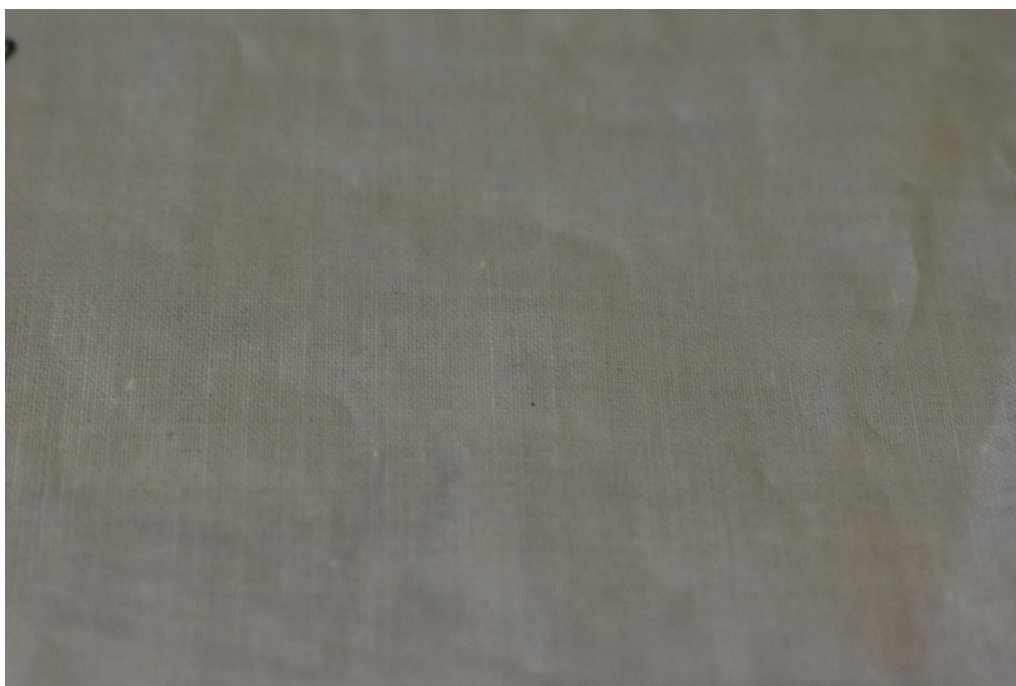
Εικόνα 3-4. Ύφασμα σχεδίασης (ή πανίχαρτο). Η φωτογραφία χρησιμοποιείται μετά από άδεια. © Αγγελική Νατσίκου
