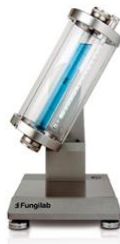
Εικόνα 27: Ιξωδομέτρο πίπτουσας σφαίρας Hoppler (Viscoba)
