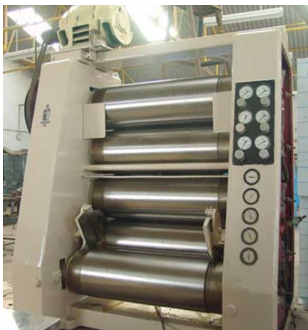
Εικόνα 13: Αριστερά: Πεντακύλινδρος υπερσυμπιεστής. Δεξιά: Μέθοδος λειτουργίας του.
