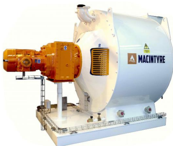
Εικόνα 15: Συmpαγή συστήματα conch (κονσών). Αριστερά: MacIntyre Δεξιά: Netzch
