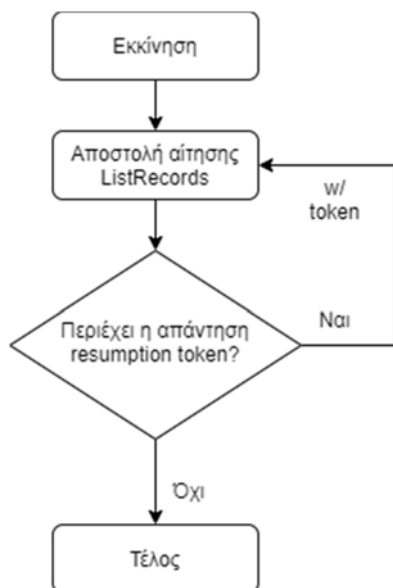
Σχήμα 1: Αλγόριθμος λήψης οντοτήτων με χρήση του resumption token στο πρωτόκολλο OAI-PMH.
