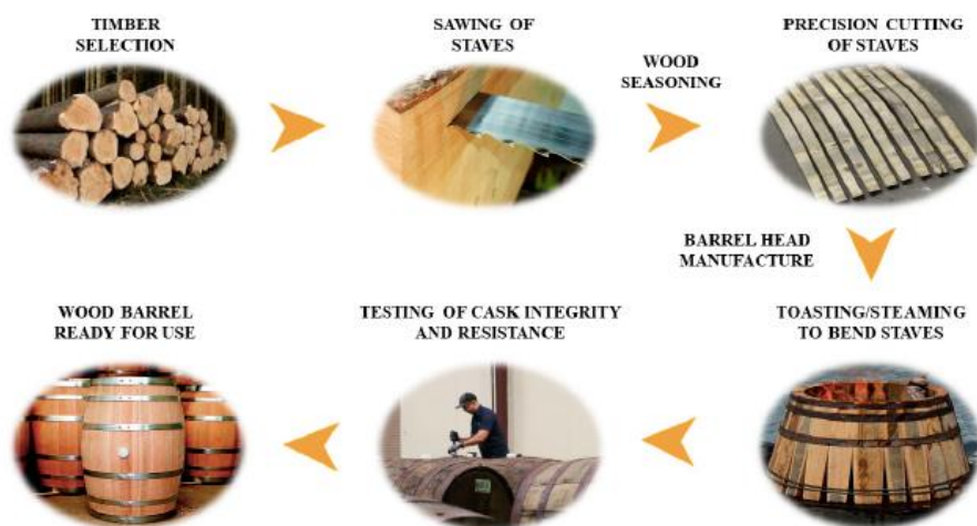
Εικόνα: Στάδια κατασκευής βαρελιών
