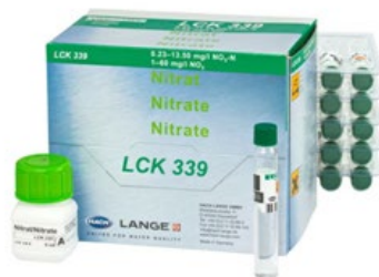
Εικόνα 4.37 Kit κυψελίδων προσδιορισμού νιτρικών ιόντων ( https://gr.hach.com )
