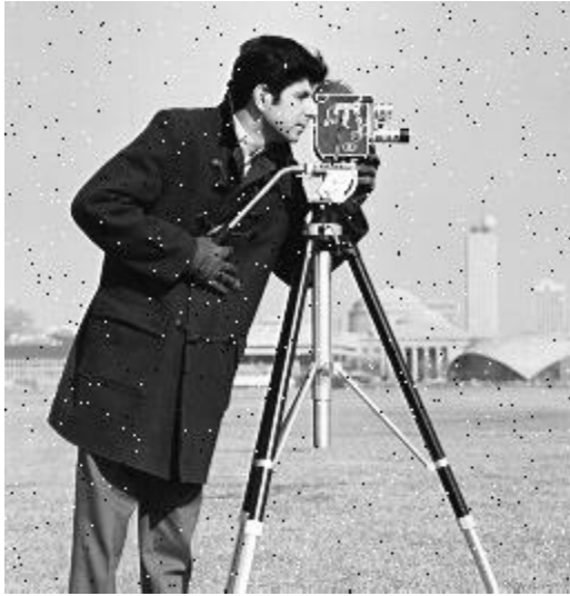
Εικόνα 3.8β: Εικόνα με πρόσθετο θόρυβο salt & pepper ισχύος 0.01
