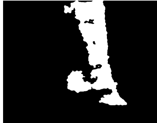
Εικόνα 4.4δ: Εικόνα μετά την εφαρμογή region growing και βαθυπερατού φίλτρου με D=50
