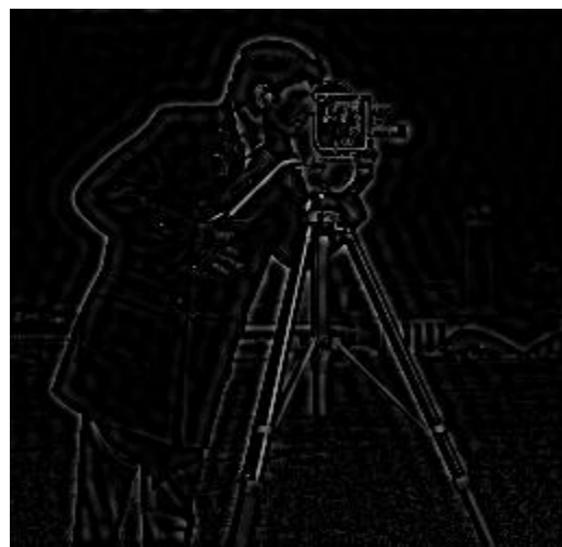
Εικόνα 3.6β: Εικόνα μετά από εφαρμογή high pass filter με D=25
