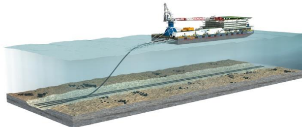
Σχήμα 4.6: Σύνδεση αγωγών με φορτηγίδα (πηγή https://www.vanoord.com/activities/shallow-water-pipe-lay-barge )
