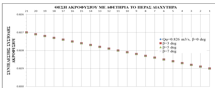
Σχήμα 5.9.5: Τιμές συντελεστή συστολής C_d ανά διατομή ακροφυσίου για είκοσι ένα ακροφύσια με διερχόμενη παροχή Q_{\phi} = 0.826 \text{ m}^3/\text{s} και γωνίες 0, 3, 5 και 7^{\circ} .
