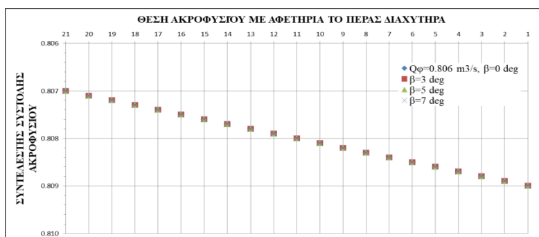
Σχήμα 5.7.5: Τιμές συντελεστή συστολής C_d ανά διατομή ακροφυσίου για διαχυτήρα με είκοσι ένα στόμια για αρχική παροχή Q_{\phi} = 0.806 \text{ m}^3/\text{s} και γωνίες 0, 3, 5 και 7^{\circ} .
