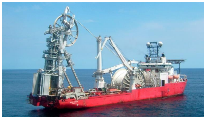
Σχήμα 4.5: Ξετύλιγμα γραμμής αγωγών από φορτηγίδα (πηγή https://www.royalihc.com/en/products/offshore/pipelay/reel-lay-vessels )
