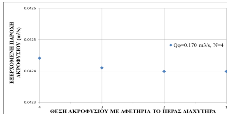
Σχήμα 5.5.2: Τιμές εκρέουσας παροχής λυμάτων από τα ακροφύσια του διαχυτήρα ανά διατομή για αρχική παροχή Q_\phi = 0.170 \text{ m}^3/\text{s} και γωνία 0^\circ
