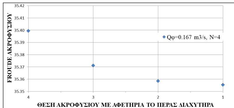
Σχήμα 5.4.6: Τιμές πυκνομετρικού αριθμού Froude ανά διατομή για αρχική παροχή Q_\phi = 0.167 \text{ m}^3/\text{s} και γωνία 0^\circ .
