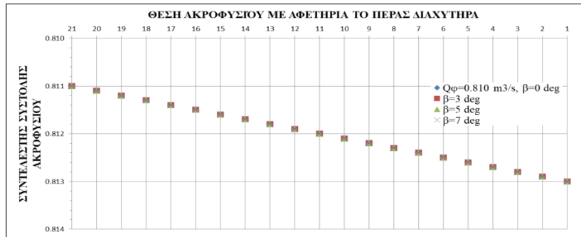
Σχήμα 5.8.5: Τιμές συντελεστή συστολής C_d ανά διατομή ακροφυσίου για είκοσι ένα στόμια με Q_\phi=0.810 m^3/s και γωνίες 0, 3, 5 και 7^\circ .
