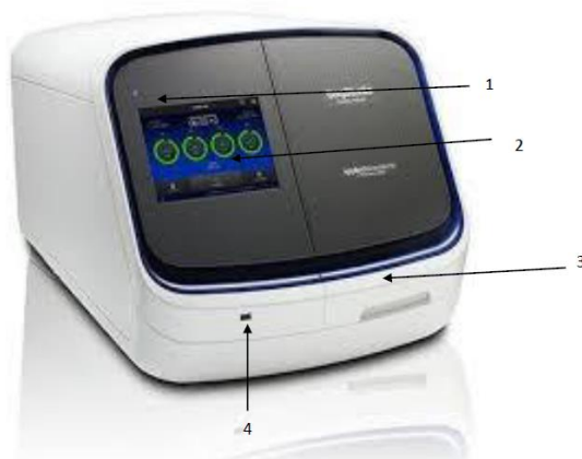
Εικόνα 2.4 Γενετικός αναλυτής Thermo ABI SeqStudio. 1.Πίνακας ένδειξης - κατάσταση αναλυτή, 2.Οθόνη αφής, 3.Πόρτα αναλυτή-πρόσβαση κασέτας, ρυθμιστικού διαλύματος καθόδου, πλάκας μικροτιπλοδότησης ή σωληναρίων, 4.Θύρα USB.
