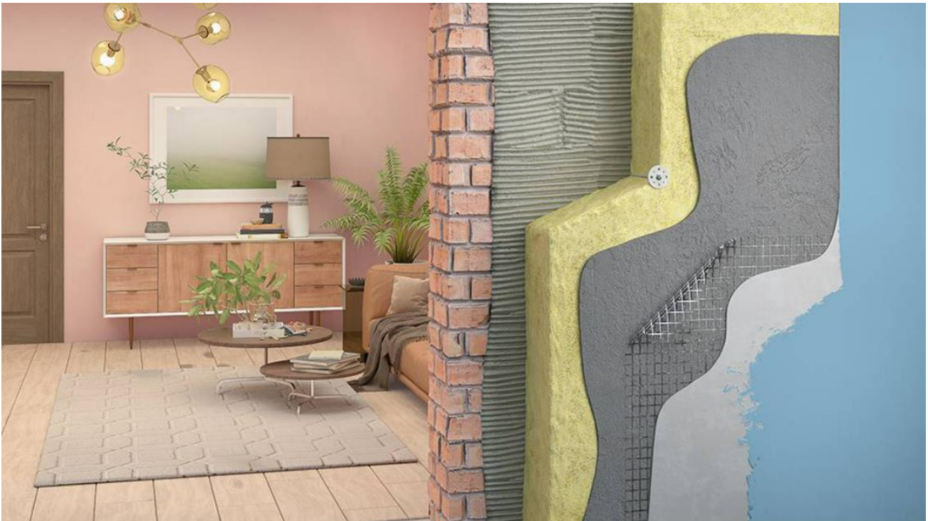
Εικόνα 19: Στρώσεις εξωτερικής θερμομόνωσης (μπογιά, σοβάς, τούβλο, συνθετικό κονίαμα, θερμομόνωση, συνθετικό κονίαμα, πλέγμα, σοβάς, μπογιά) [49]
