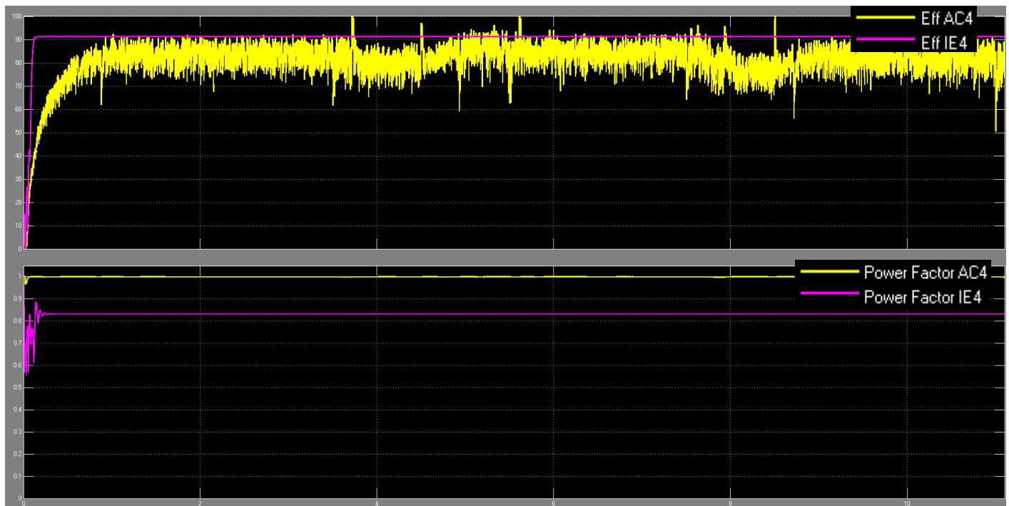
Σχήμα 4.112 Σύγκριση γραφημάτων για το σύστημα μονάδας ελέγχου D.T.C. - κινητήρα και τον κινητήρα κλάσης IE4 όπου λειτουργούν παράλληλα. Καταγράφεται η απόδοση %, και ο συντελεστής ισχύος, σε σχέση με τον χρόνο.
