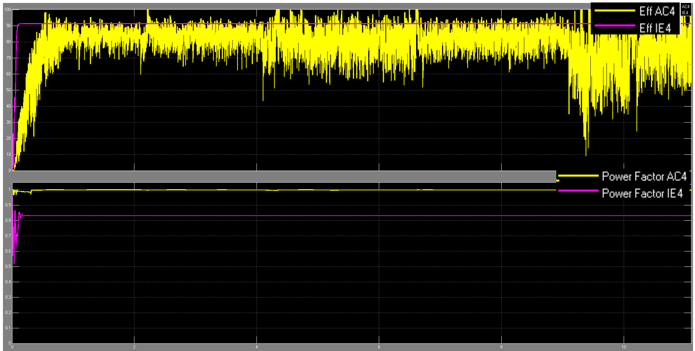
Σχήμα 4.92 Σύγκριση γραφημάτων για το σύστημα μονάδας ελέγχου D.T.C. - κινητήρα και τον κινητήρα κλάσης IE4 όπου λειτουργούν παράλληλα. Καταγράφεται η απόδοση %, και ο συντελεστής ισχύος, σε σχέση με τον χρόνο.
