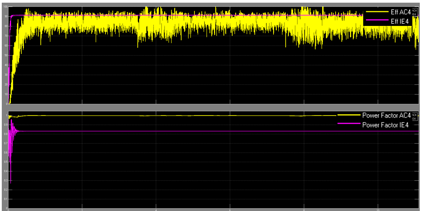
Σχήμα 4.102 Σύγκριση γραφημάτων για το σύστημα μονάδας ελέγχου D.T.C. - κινητήρα σε και τον κινητήρα κλάσης IE4 όπου λειτουργούν παράλληλα. Καταγράφεται η απόδοση %, και ο συντελεστής ισχύος, σε σχέση με τον χρόνο.
