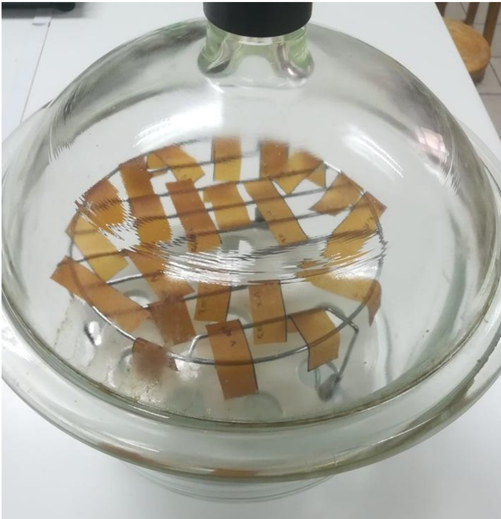
Εικόνα 6: Τα δείγματα των μεμβρανών κομμένα σε λωρίδες τοποθετημένα σε ξηραντήρια με MgCl_2 \cdot 6H_2O
