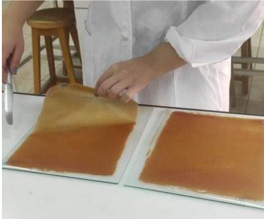
Εικόνα 4: Αποκόλληση μεμβρανών από τις γυάλινες πλάκες μετά από εξισορρόπηση της υγρασίας με το περιβάλλον
