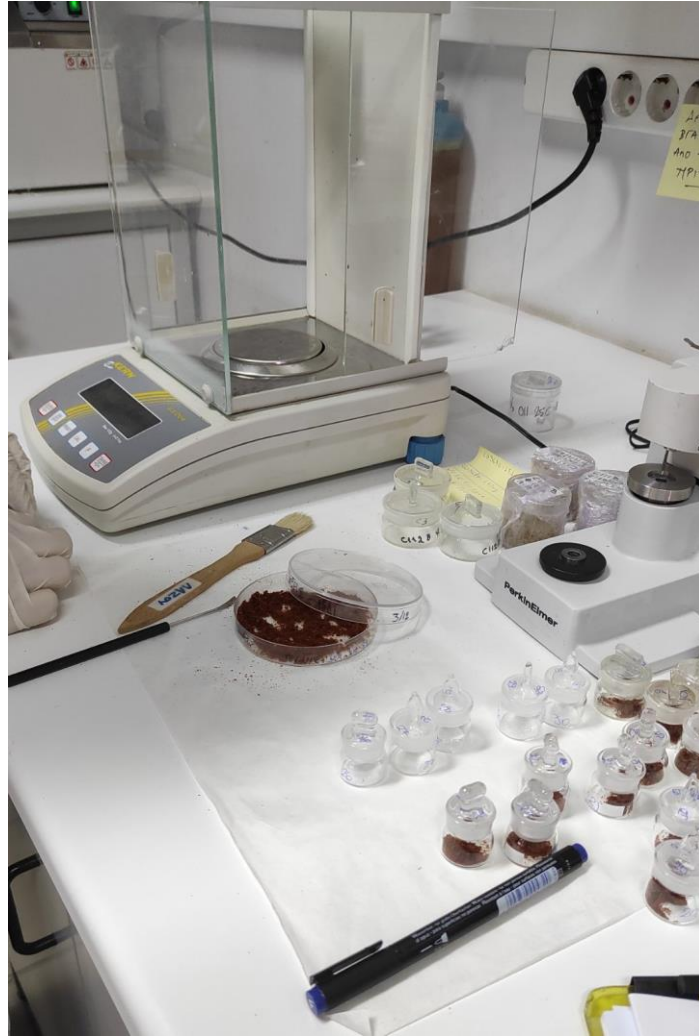
Εικόνα 7: Ζύγιση κονιοποιημένου δείγματος και μεταφορά στα προζυγισμένα φιαλίδια
