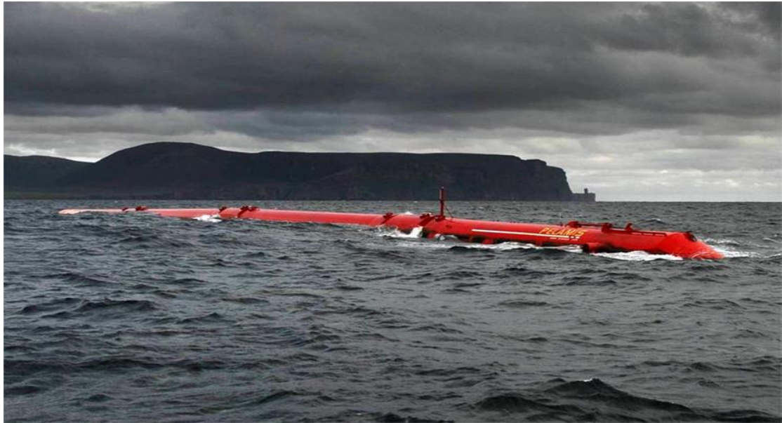
Εικόνα 12. Pelamis wave energy converter [46]
