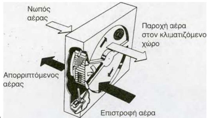
Εικόνα 12: Τρόπος λειτουργίας περιστροφικού εναλλάκτη
