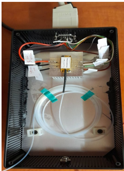
Εικόνα 1: Εσωτερική δομή Laser άντλησης στα 980 nm.
