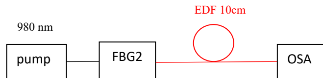
Σχήμα 25: Διάταξη μέτρησης θορύβου ASE με χρήση του FBG2 και ίνας Ερβίου μήκους 10cm.
