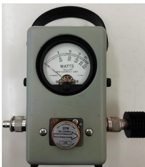
Εικόνα 2.2.8 – Γέφυρα Στάσιμων Κυμάτων Της Bird Σε Διάταξη Μέτρησης Προσπίπτουσας Ισχύος Στο Φορτίο
