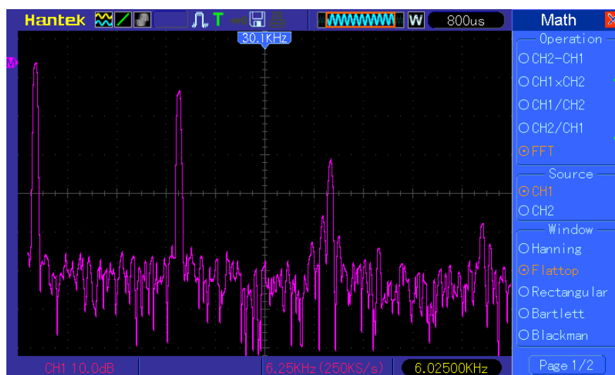
Εικόνα 2.1.28 – Φασματική Ανάλυση Σήματος Εξόδου Στερ. Κωδικ. Για Σήμα Εισόδου 1kHz (L & R Chan)
