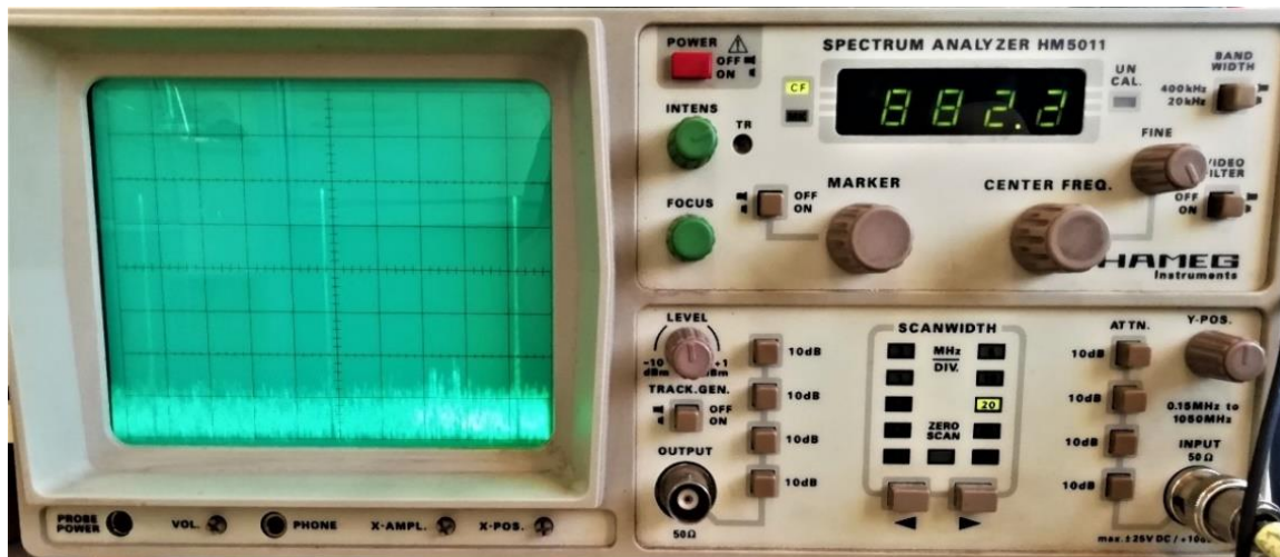
Εικόνα 2.2.11 – Φασματική Ανάλυση 8 ης , 9 ης και 10 ης αρμονικής Απλού VCO
