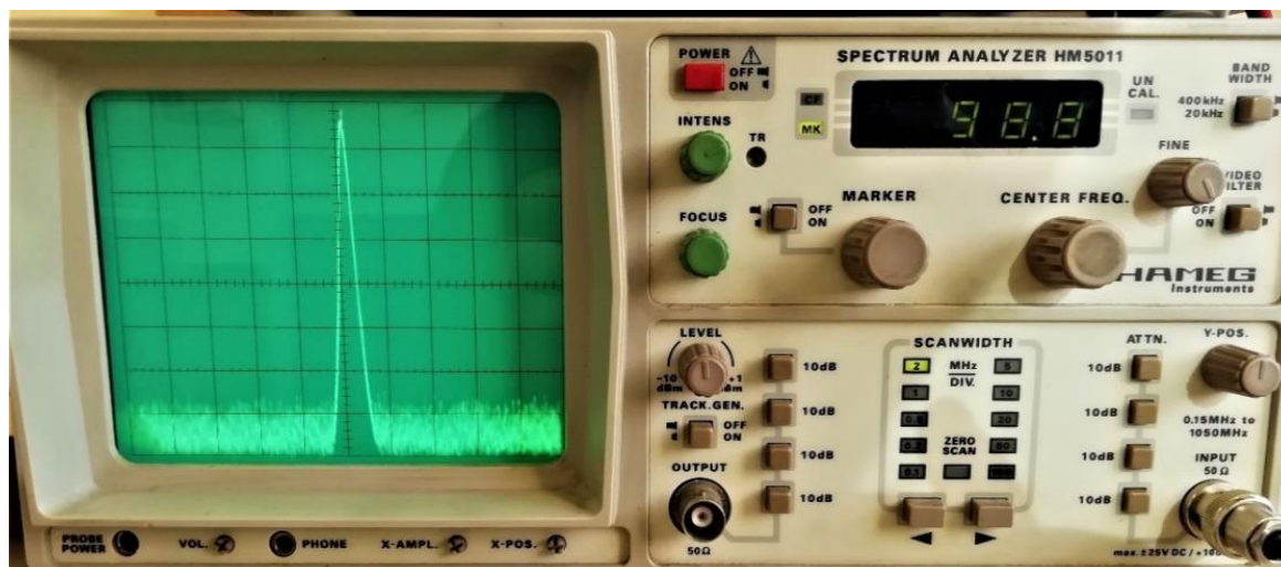
Εικόνα 2.2.10 – Φασματική Ανάλυση Εξόδου VCO Για Συχνότητα Φέροντος 98,8MHz
