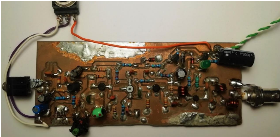
Εικόνα 2.2.7 – Άνω Όψη Τυπωμένου Κυκλώματος Απλού VCO Πλήρως Συναρμολογημένο
