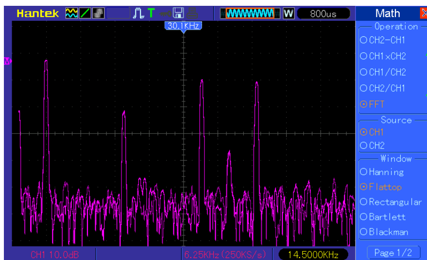
Εικόνα 2.1.26 – Φασματική Ανάλυση Σήματος Εξόδου Στερ. Κωδικ. Για Σήμα Εισόδου 5kHz (Left Chan)
