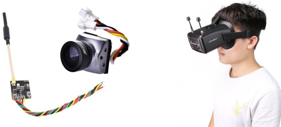
Εικόνα 42 Βιντεοπομπός VTX και γυαλιά πτήσης first person view
