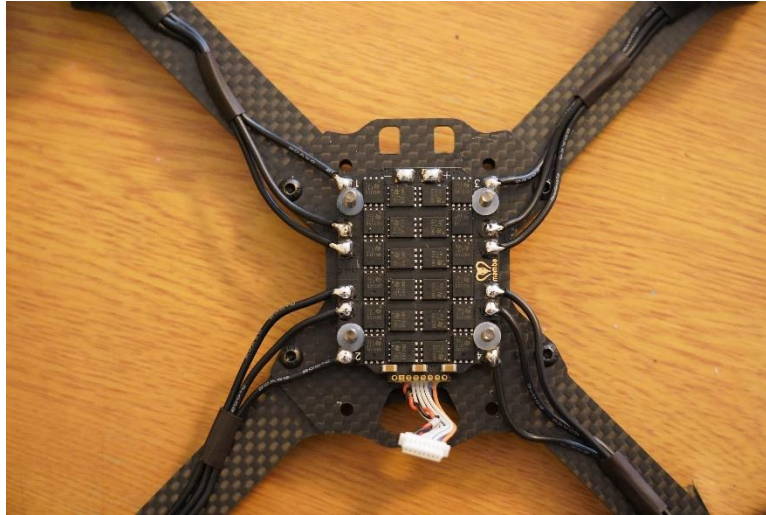
Εικόνα 15 Το πλαίσιο με το ESC μετά τις κολλήσεις
