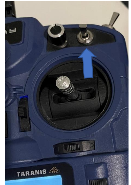
Εικόνα 37 Θέσεις για Angle και Horizon mode και μοχλός που τα ενεργοποιεί
