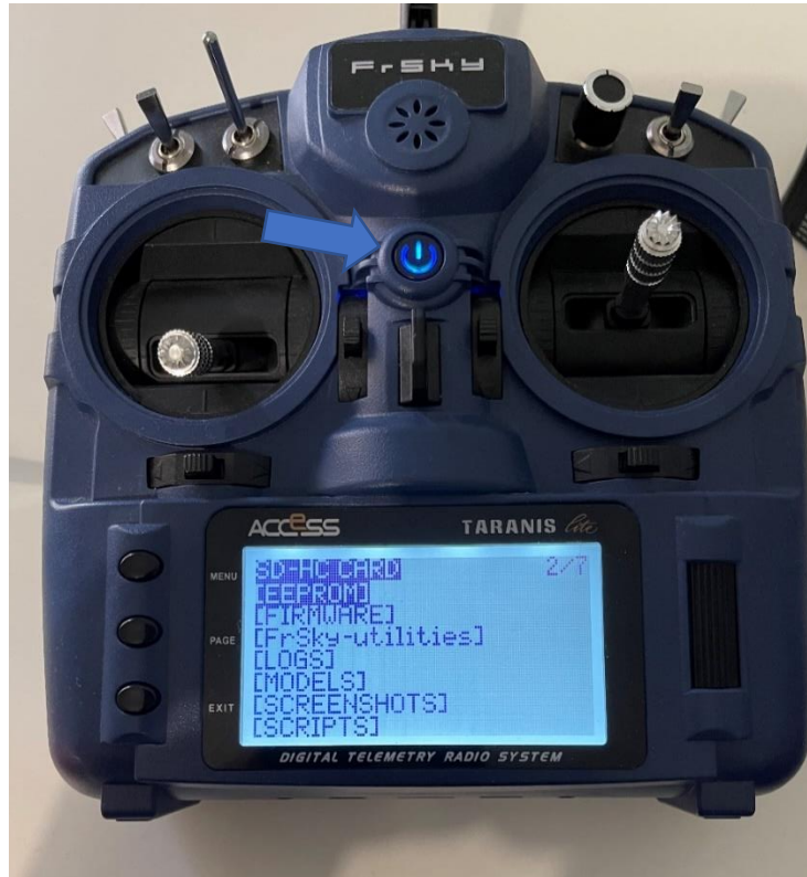
Εικόνα 24 Εγκατάσταση τελευταίου λογισμικού Open Tx στην τηλεκατεύθυνση
