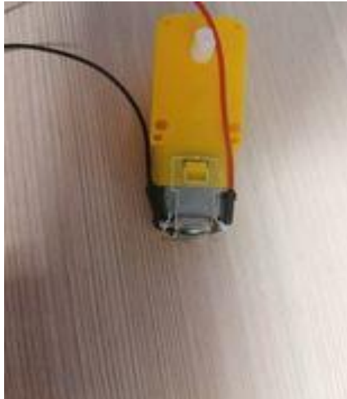
Εικόνα 75: Κόλληση καλωδίων - Κινητήρα
