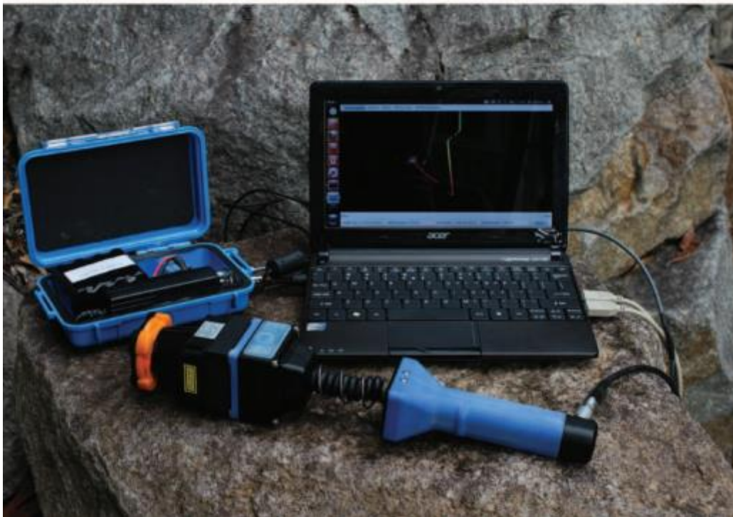
Εικόνα 5.2: Χαρτογράφηση σπηλαίου Koonalda με τη συσκευή ZEBEDEE και τα αντίστοιχα μέρη που την αποτελούν (Zlot & Bosse, 2014).
