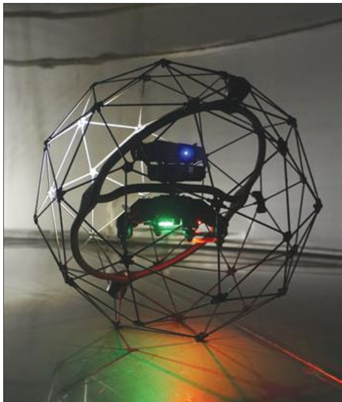
Εικόνα 5.7: Σύστημα μη επανδρωμένου αεροσκάφους κατάλληλο για πτήση εντός σπηλαίου
