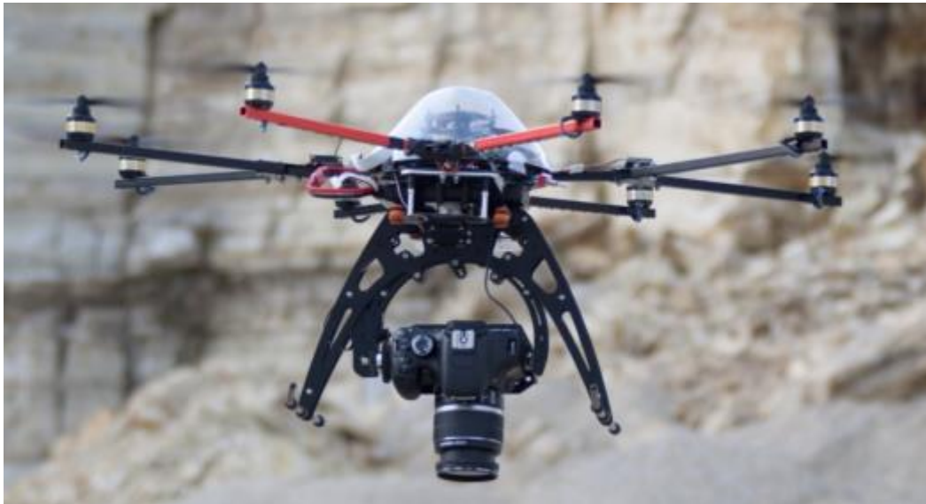
Εικόνα 3.4: Παράδειγμα drone (oktokopter) με προσαρτημένη ψηφιακή φωτογραφική μηχανή τοποθετημένη κατακόρυφα προς τα κάτω (Turner et al, 2012)
