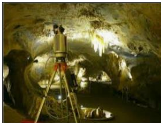
Εικόνα 3.3: Terrestrial LiDAR σε αποτύπωση σπηλαίου
