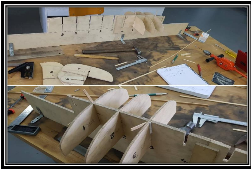
Εικόνα 3.1-13: Συγκόλληση νομέων και σταθεροποίηση τους μέσω σφηνών.
