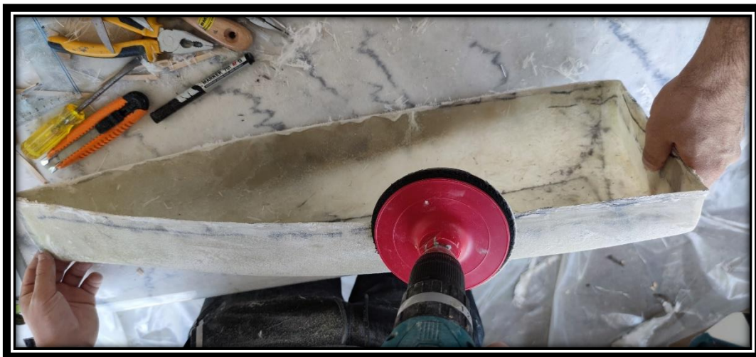
Εικόνα 3.3-22: Ομαλοποίηση ακμών καταστρώματος.
