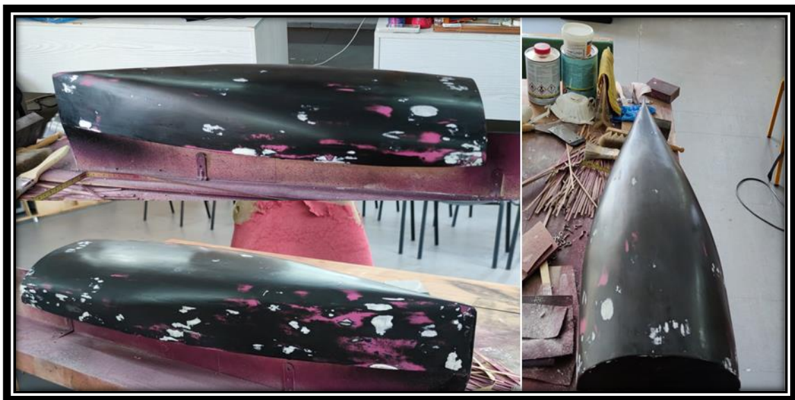
Εικόνα 3.1-33: Τελικές επιδιορθώσεις τρίτου χρωματικού στρώματος.
