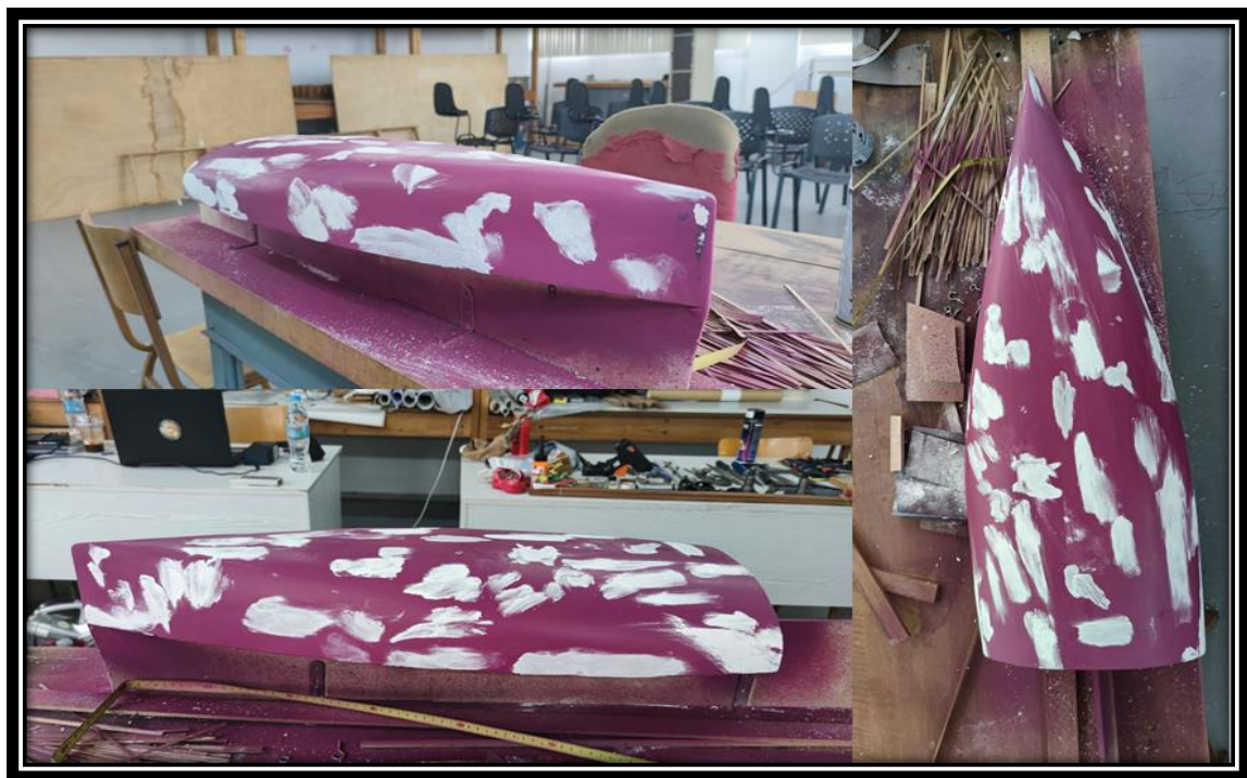
Εικόνα 3.1-29: Επιδιορθώσεις δεύτερου χρωματικού στρώματος.
