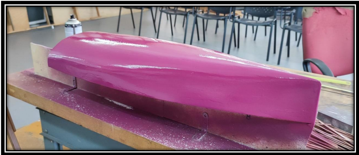
Εικόνα 3.1-28: Δεύτερο στρώμα βαφής, Magenta.
