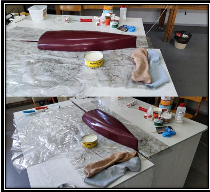
Εικόνα 3.2-2: Το πρωτότυπο με το πέρας της προετοιμασίας της επιφάνειας.
