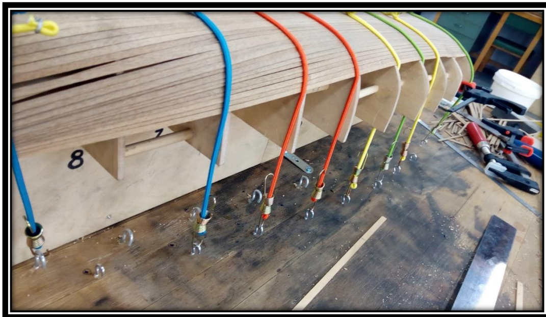
Εικόνα 3.1-17: Ελαστικοί ιμάντες συγκράτησης κελύφους.
