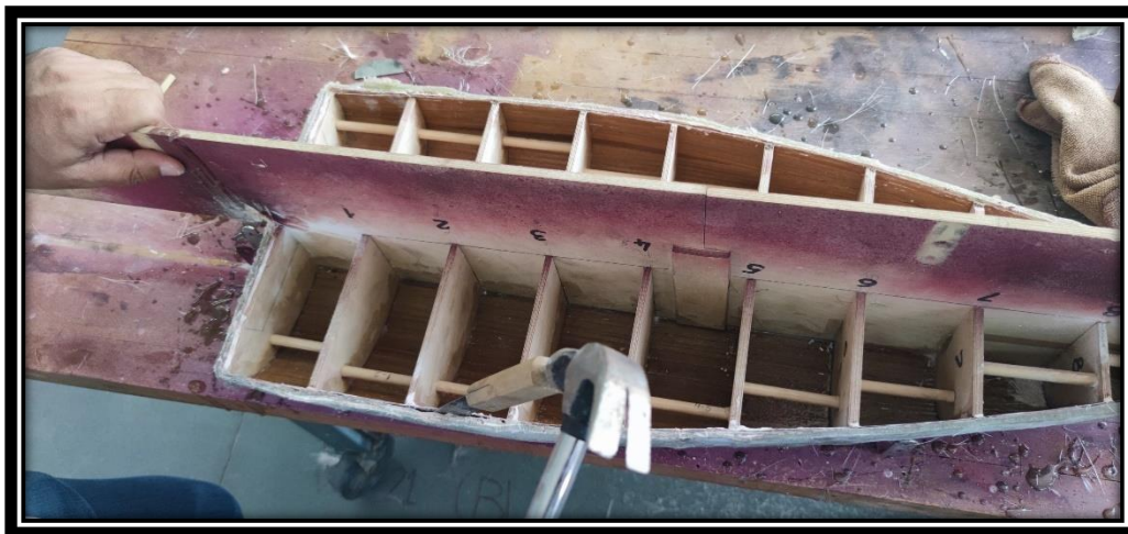
Εικόνα 3.2-12: Δημιουργία διάκενου με τη χρήση μεταλλικής λάμας.
