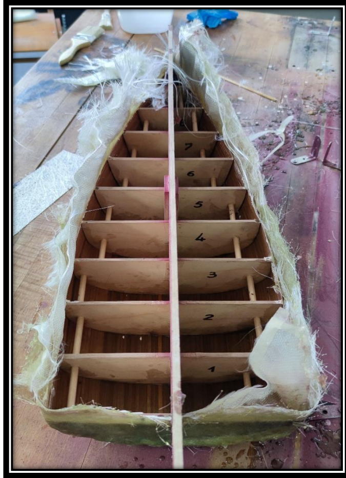
Εικόνα 3.2-8: Απεικόνιση καλουπιού πριν την αφαίρεση περίσσειας πολυεστέρα.
