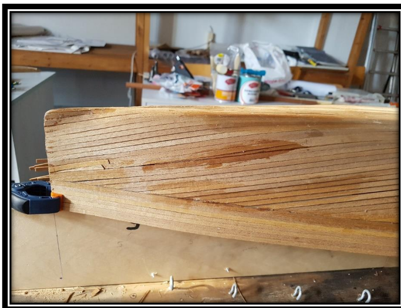
Εικόνα 3.1-20: Ολοκλήρωση κελύφους, starboard πλώρη έως μέση τομή.
