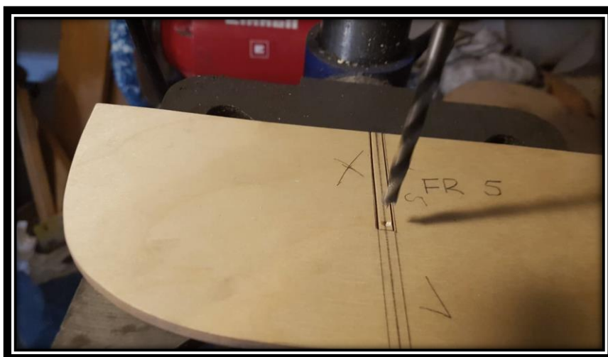
Εικόνα 3.1-11: Διαδικασία διαμόρφωσης εγκοπών στους νομείς.
