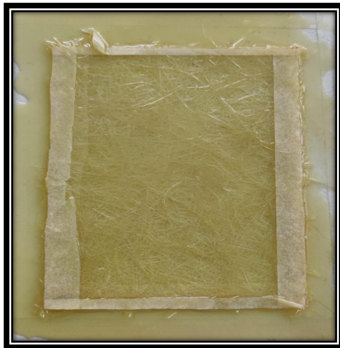
Εικόνα 3.2-1: Πειραματικό πολυεστερικό δοκίμιο.
