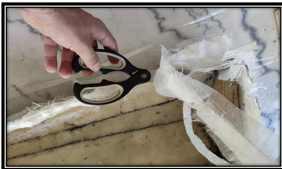
Εικόνα 3.3-16: Αφαίρεση περίσσειας υφασμάτων με χρήση ψαλιδιού.
