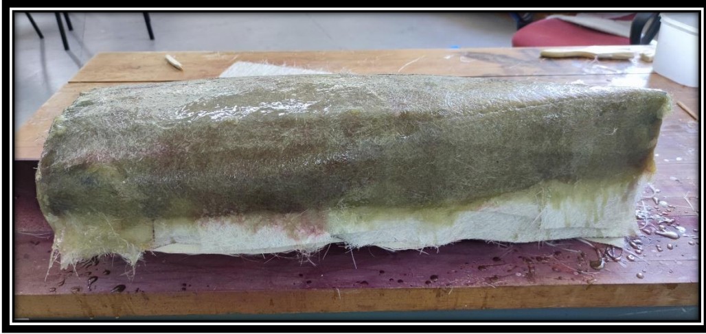
Εικόνα 3.2-5: Κατασκευή καλουπιού, πλάγια όψη.
