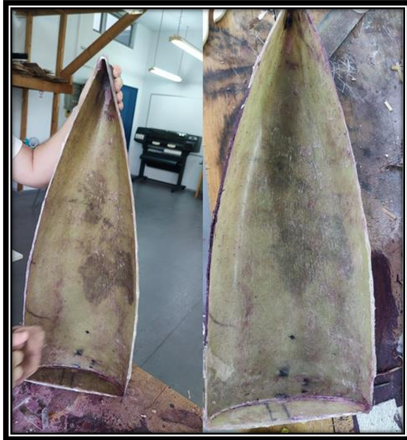
Εικόνα 3.2-17: Καθαρισμός εσωτερικής επιφάνειας (1/2).
