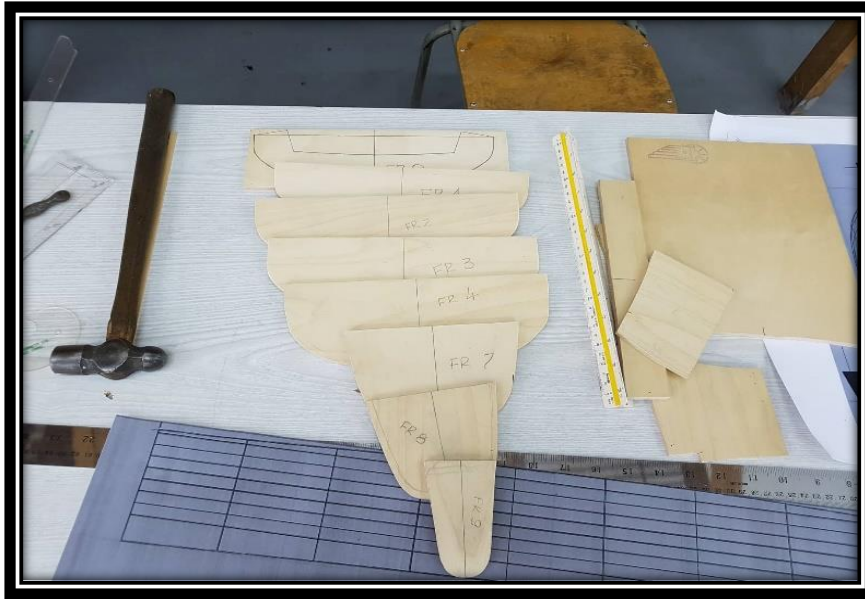
Εικόνα 3.1-8: Νομείς πριν την τελική διαμόρφωση.
