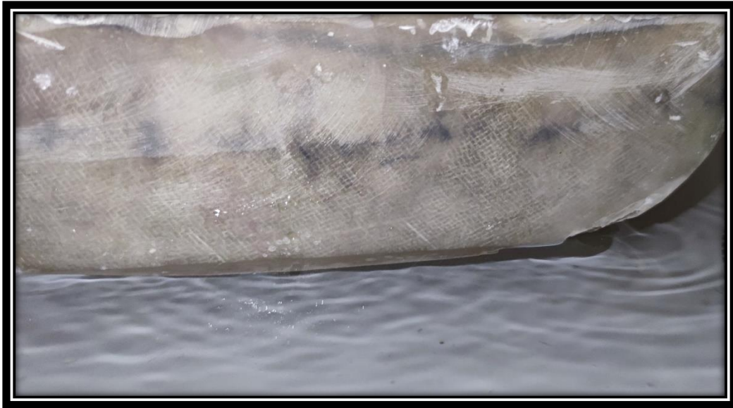
Εικόνα 3.3-23: Απεικόνιση του τραυματισμού της πλώρης κατά τον έλεγχο στεγανότητας.
