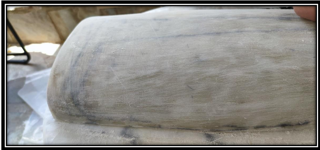
Εικόνα 3.3-26: Αρχική απόξεση του μοντέλου με υαλόχαρτο P180.
