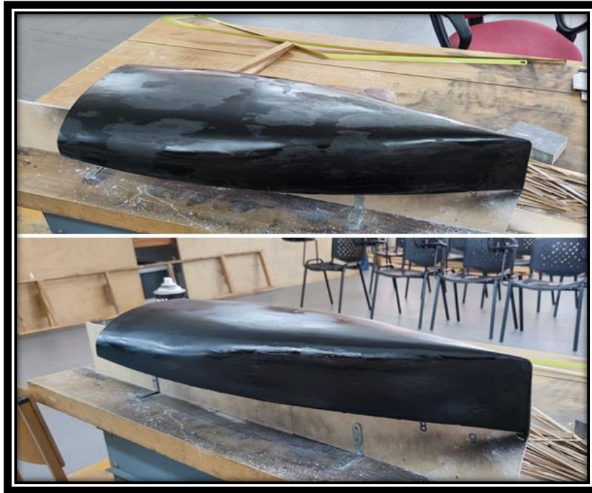
Εικόνα 3.1-27: Ολοκλήρωση αρχικής βαφής.
