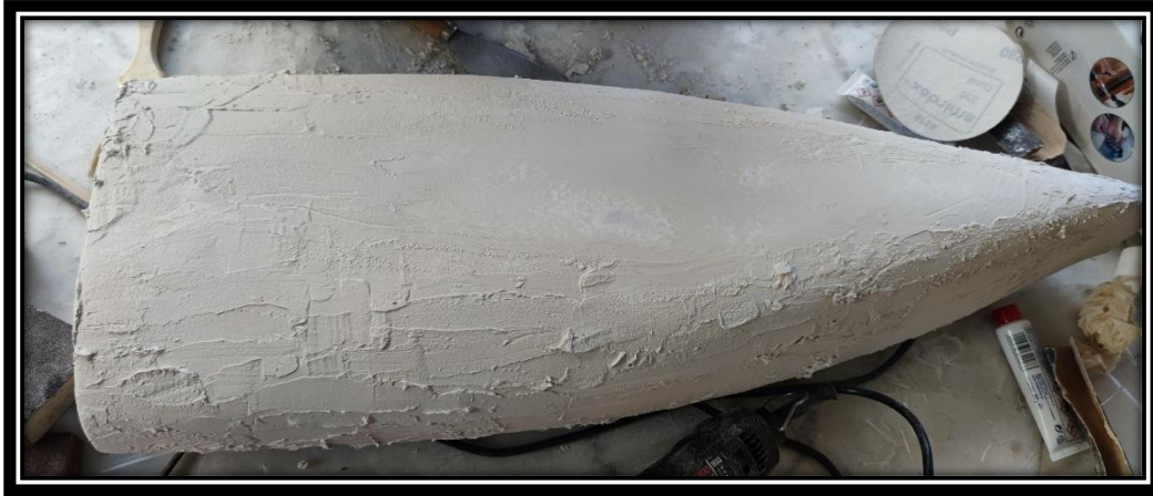
Εικόνα 3.3-28: Επικάλυψη του μοντέλου με φίνο σιδηρόστοκο.
