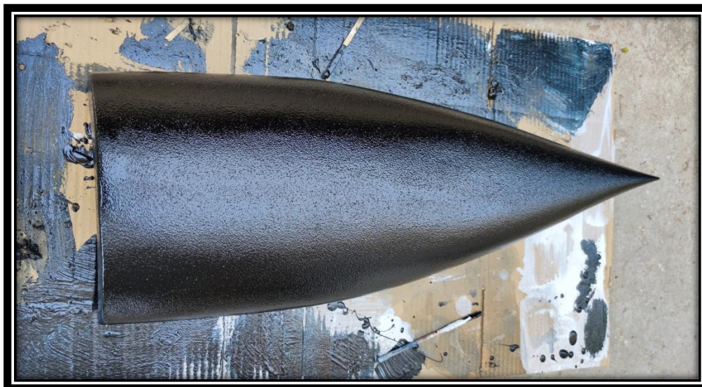
Εικόνα 3.3-33: Εναπόθεση Gel Coat με γούνινο ρολό.
