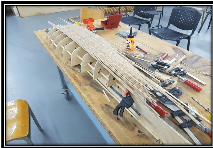
Εικόνα 3.1-16: Τοποθέτηση σανίδων κελύφους (2/2).
