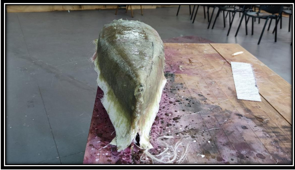
Εικόνα 3.2-7: Κατασκευή καλουπιού, απεικόνιση πλώρης.
