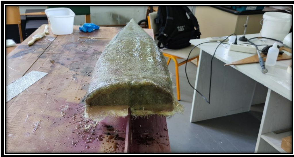
Εικόνα 3.2-6: Κατασκευή καλουπιού, απεικόνιση πρύμνης.
