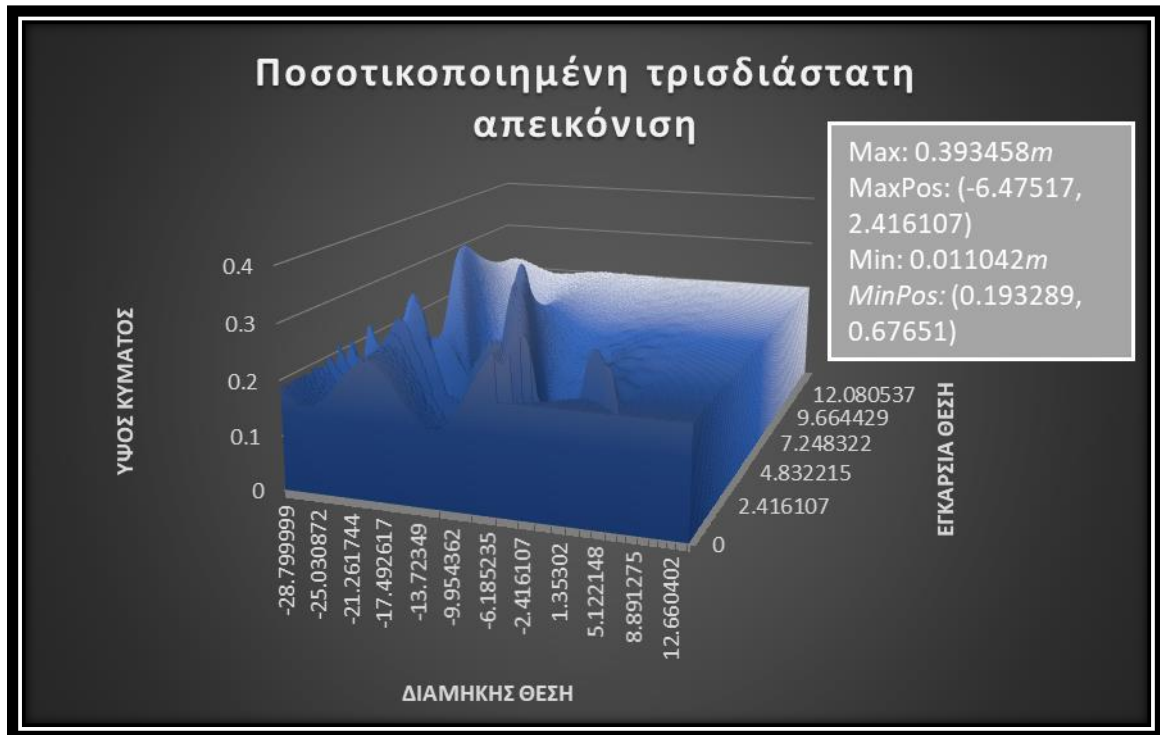
Εικόνα 4.1-46: Ποσοτικοποιημένη τρισδιάστατη απεικόνιση ύψους κύματος για V=9kn .
