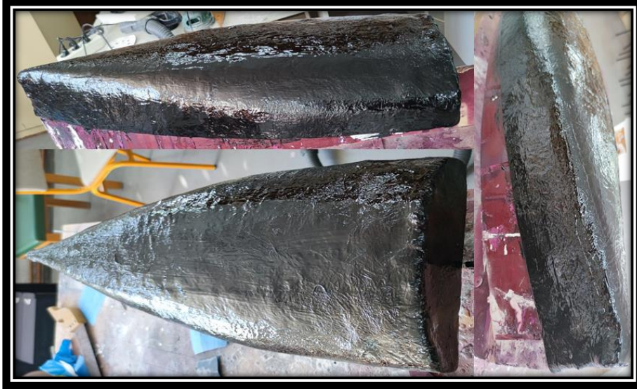
Εικόνα 3.2-22: Απεικόνιση της εξωτερικής επιφάνειας μετά την εφαρμογή Gel Coat.
