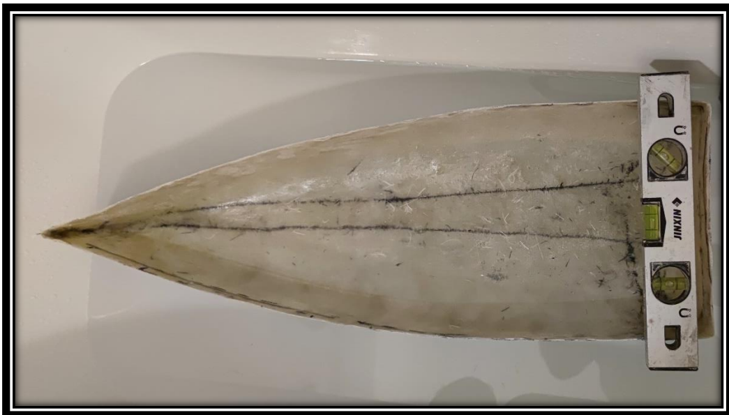
Εικόνα 3.3-24: Απεικόνιση διαδικασίας ελέγχου στεγανότητας.
