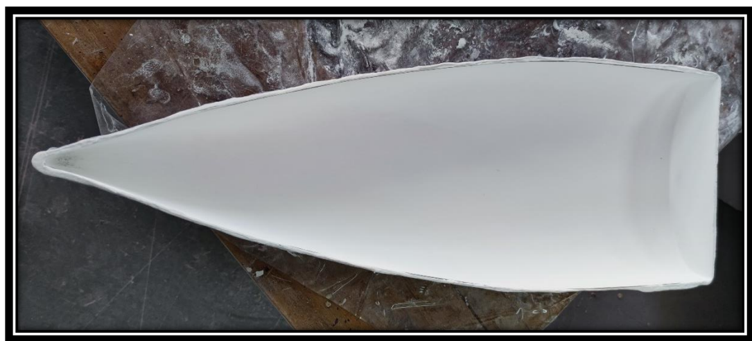
Εικόνα 3.2-28: Ολοκλήρωση διαδικασίας λείανσης.
