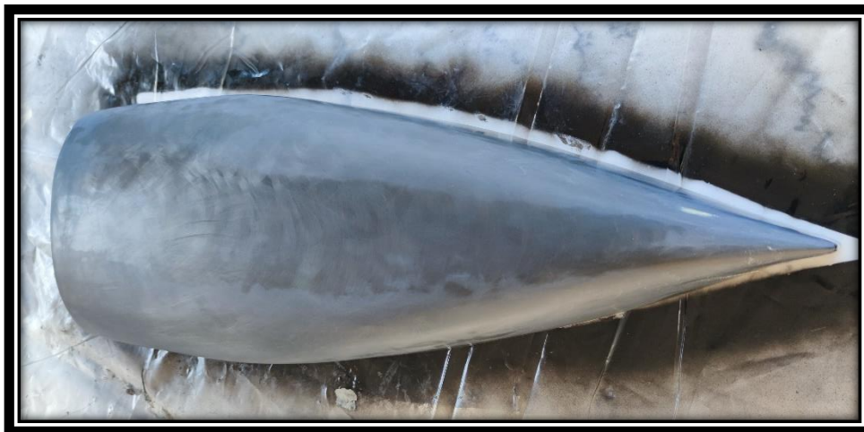
Εικόνα 3.3-39: Ολοκλήρωση δεύτερης φάσης της λείανσης.
