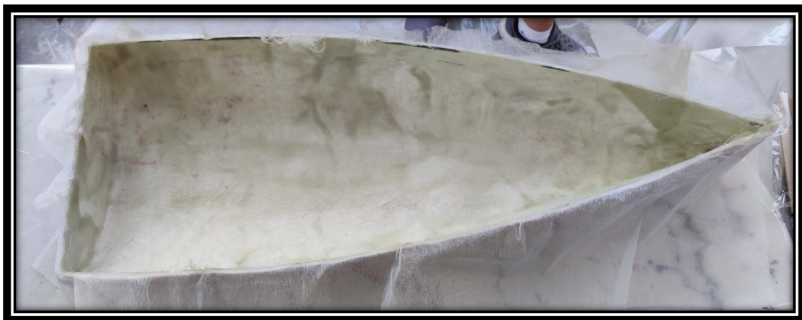
Εικόνα 3.3-12: Τοποθέτηση κι εμποτισμός υφάσματος τύπου αράχνης.
