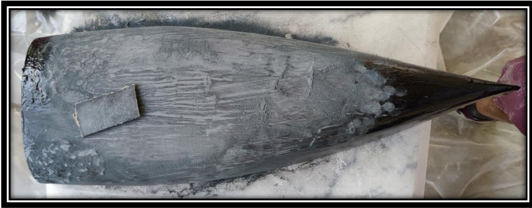
Εικόνα 3.3-31: Τριβή της εξωτερικής επιφάνειας.
