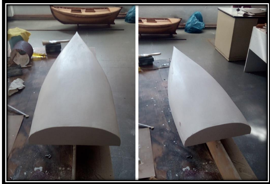
Εικόνα 3.1-25: Το μοντέλο μετά το πέρας των εργασιών του τρίτου κύκλου και την εφαρμογή νιτροκυτταρίνης.
