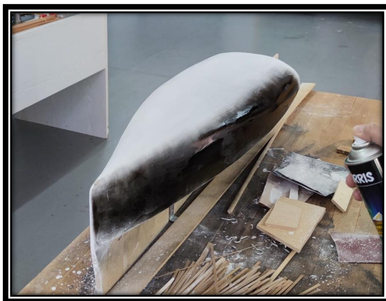
Εικόνα 3.1-26: Διαδικασία βαφής μαύρου χρώματος.
