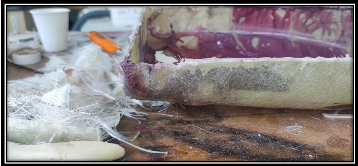
Εικόνα 3.2-10: Τραυματισμός του καλουπιού.
