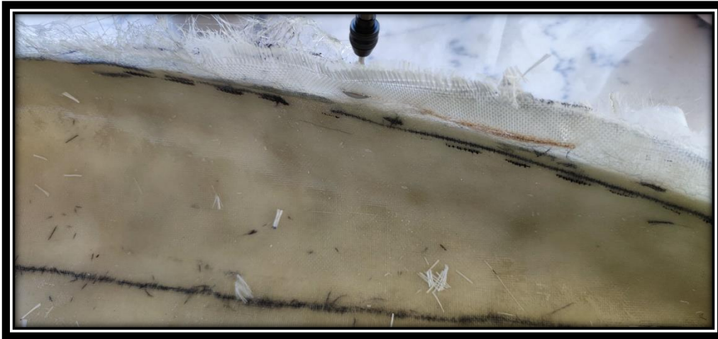
Εικόνα 3.3-17: Αφαίρεση περίσσειας υφασμάτων με χρήση κοπτικής κεφαλής σε ηλεκτρικό πολυεργαλείο.
