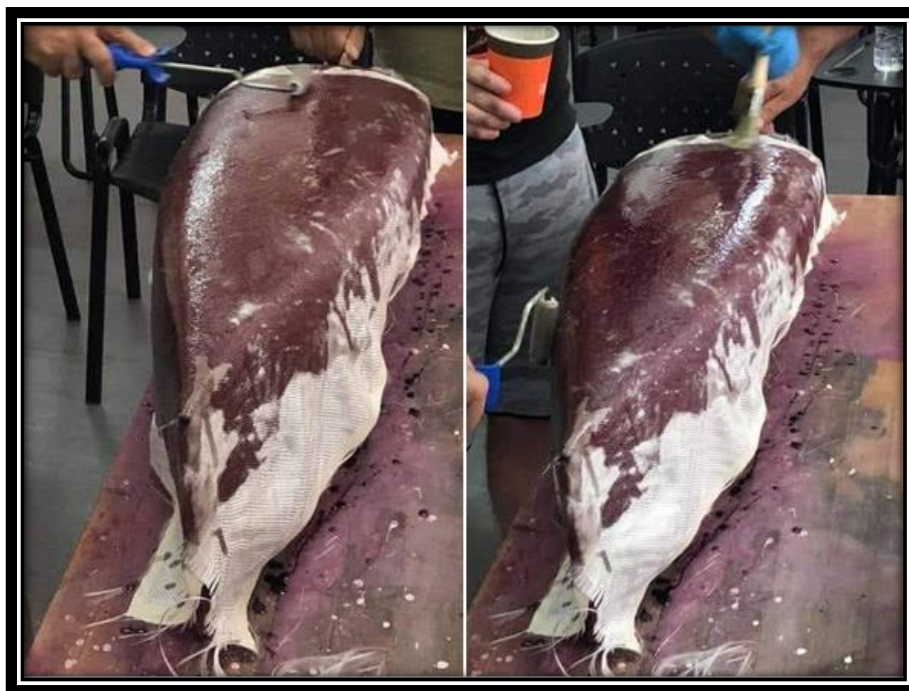
Εικόνα 3.2-4: Διαδικασία τοποθέτησης ρητίνης και υαλοϋφασμάτων.
