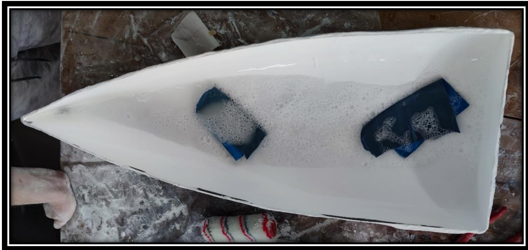
Εικόνα 3.2-27: Διαδικασία λείανσης με υαλόχαρτα νερού.
