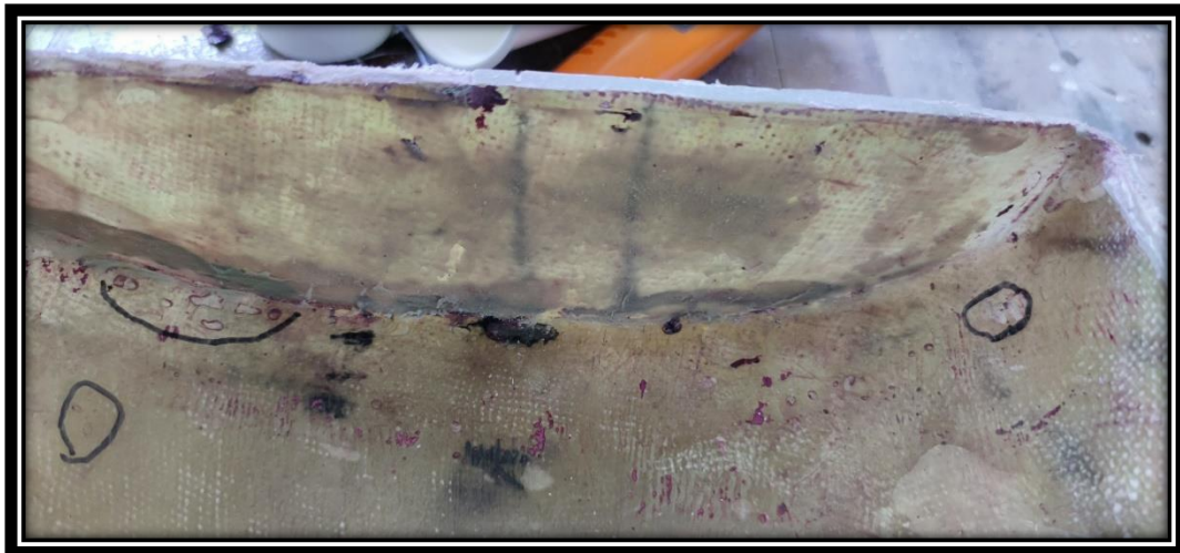
Εικόνα 3.2-19: Σφάλματα εσωτερικής επιφάνειας.
