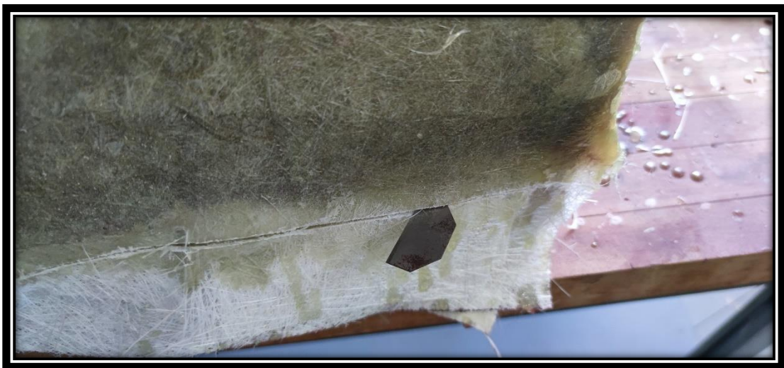
Εικόνα 3.2-9: Περιμετρική χάραξη περίσσειας πολυεστέρα στο ύψος του καταστρώματος.
