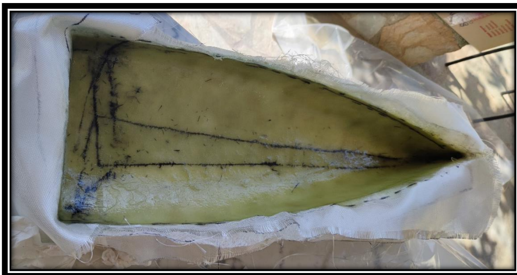
Εικόνα 3.3-15: Τοποθέτηση της τελευταίας στρώσης WR300 και ολοκλήρωση της διαδικασίας.
