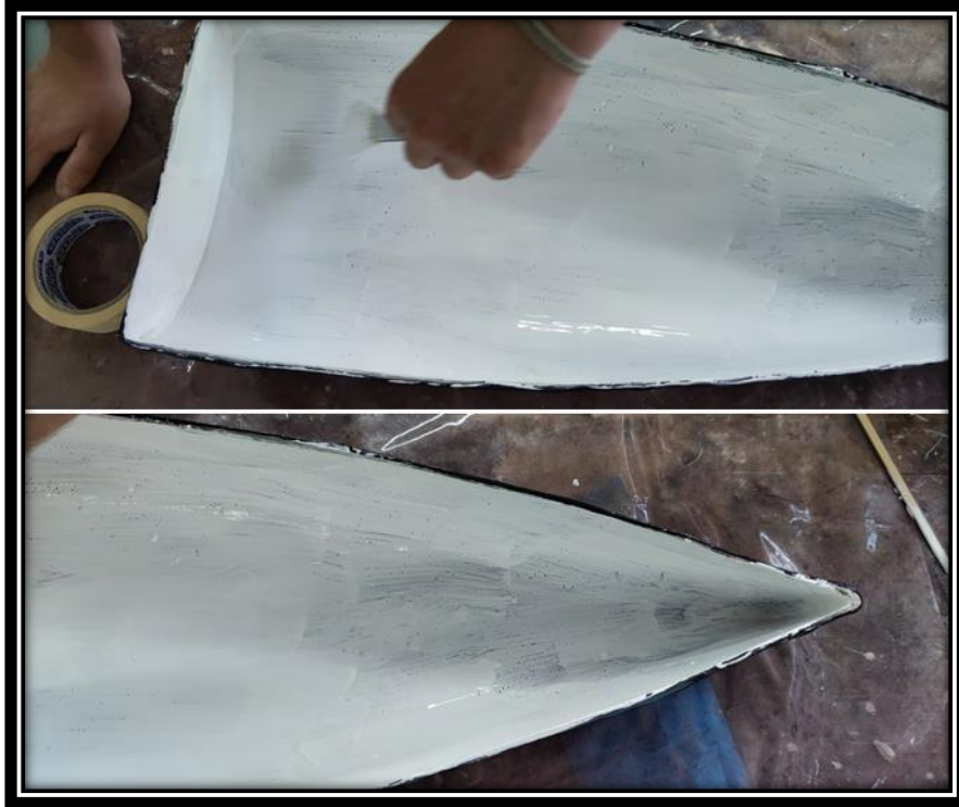
Εικόνα 3.2-23: Εφαρμογή πρώτης στρώσης Gel Coat.
