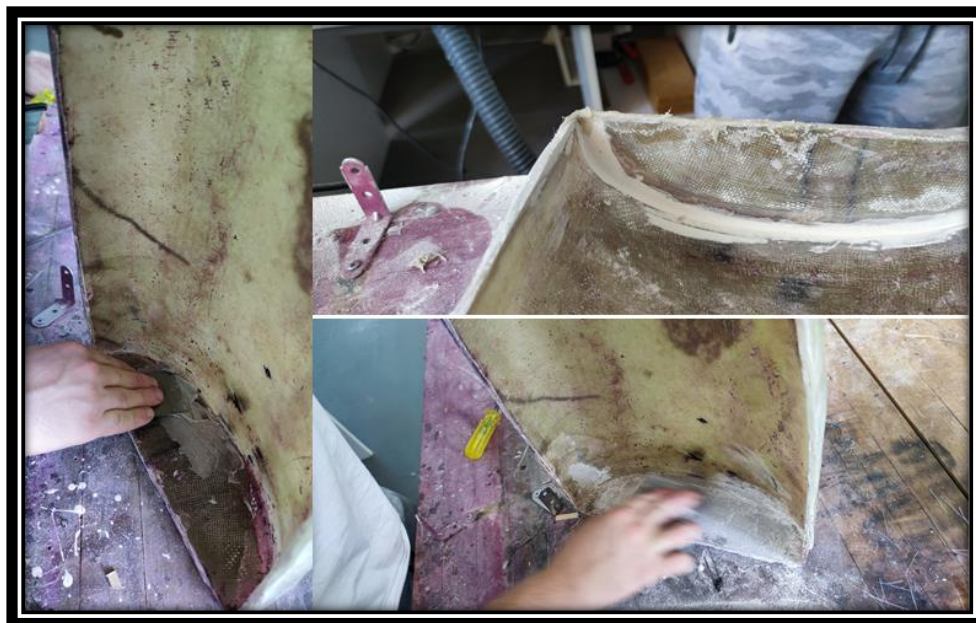
Εικόνα 3.2-21: Εφαρμογή πολυεστερικού στόκου και ομαλοποίηση της επιφάνειας.
