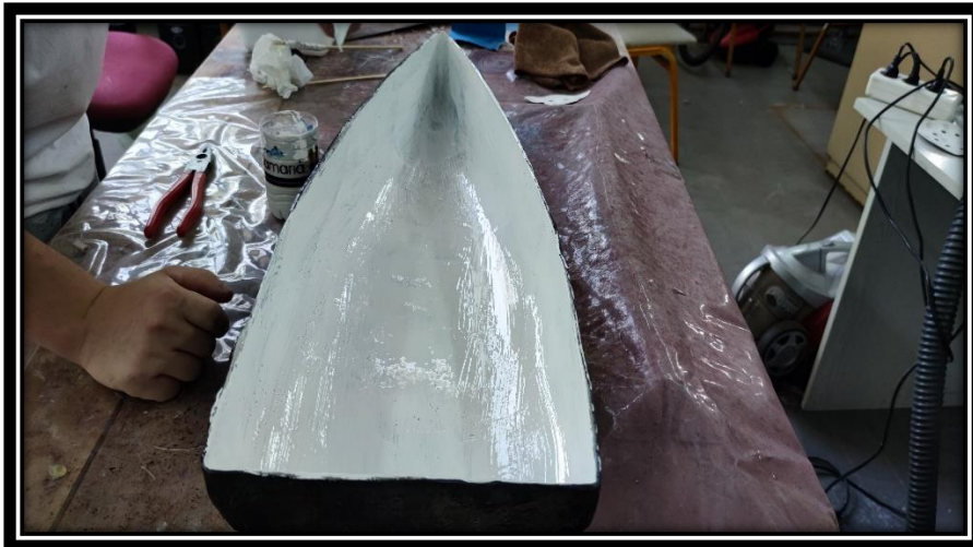
Εικόνα 3.2-24: Εφαρμογή δεύτερης στρώσης Gel Coat.
