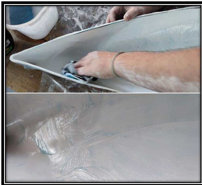
Εικόνα 3.2-29: Εφαρμογή αλοιφής γυαλισματος.
