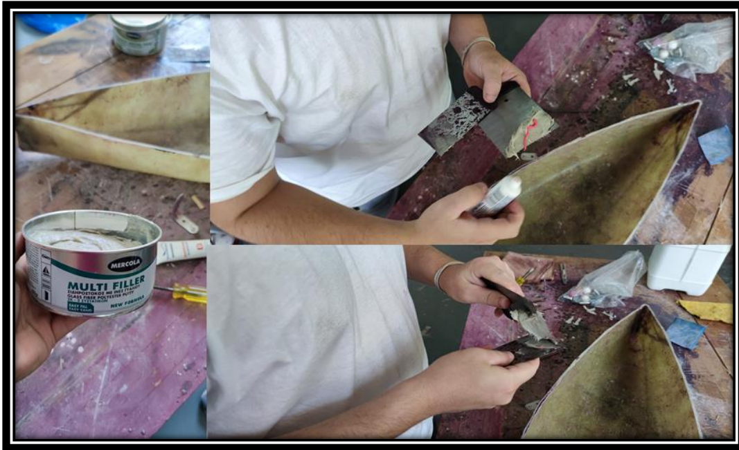
Εικόνα 3.2-20: Προετοιμασία πολυεστερικού στόκου.
