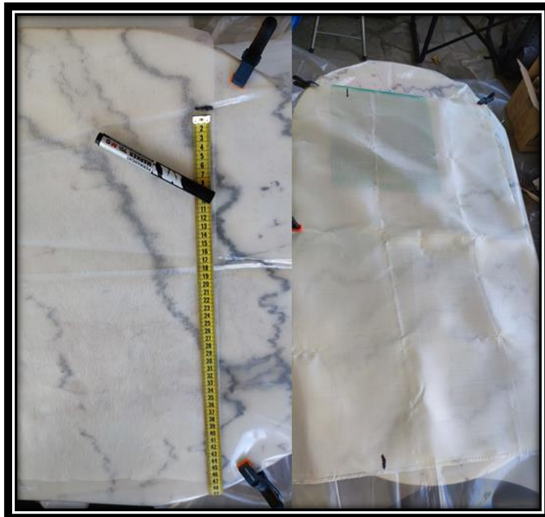
Εικόνα 3.3-2: Διαδικασία οριοθέτησης υφασμάτων.
