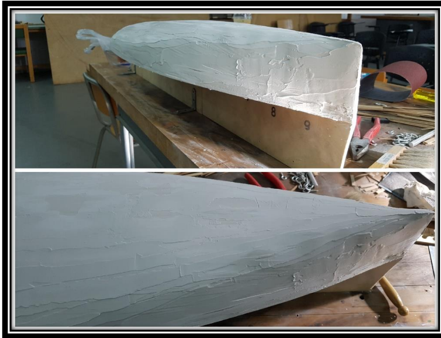
Εικόνα 3.1-22: Ενδεικτική απεικόνιση μοντέλου, έπειτα από κάθε επικάλυψη με ακρυλικό στόκο.
