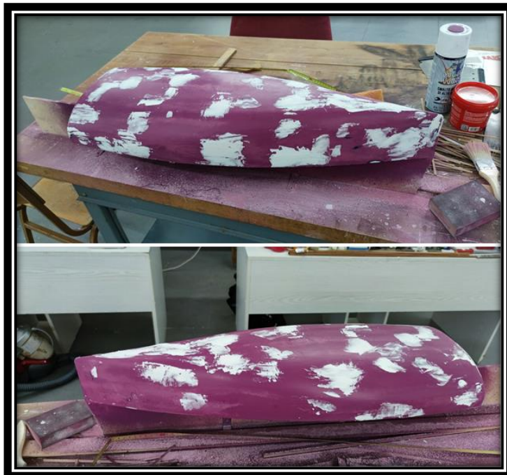
Εικόνα 3.1-30: Τελικές επιδιορθώσεις δεύτερου χρωματικού στρώματος.
