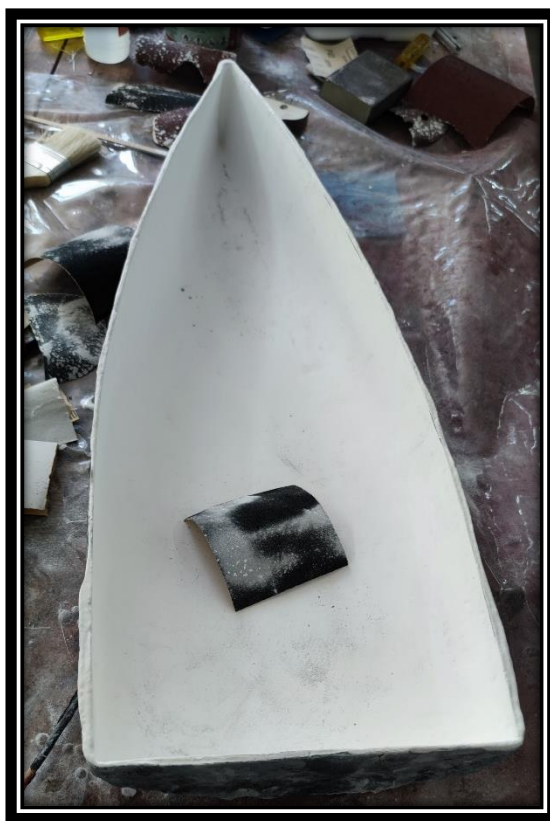
Εικόνα 3.2-26: Ομαλοποίηση επιφάνειας με υαλόχαρτα P600 και P800.
