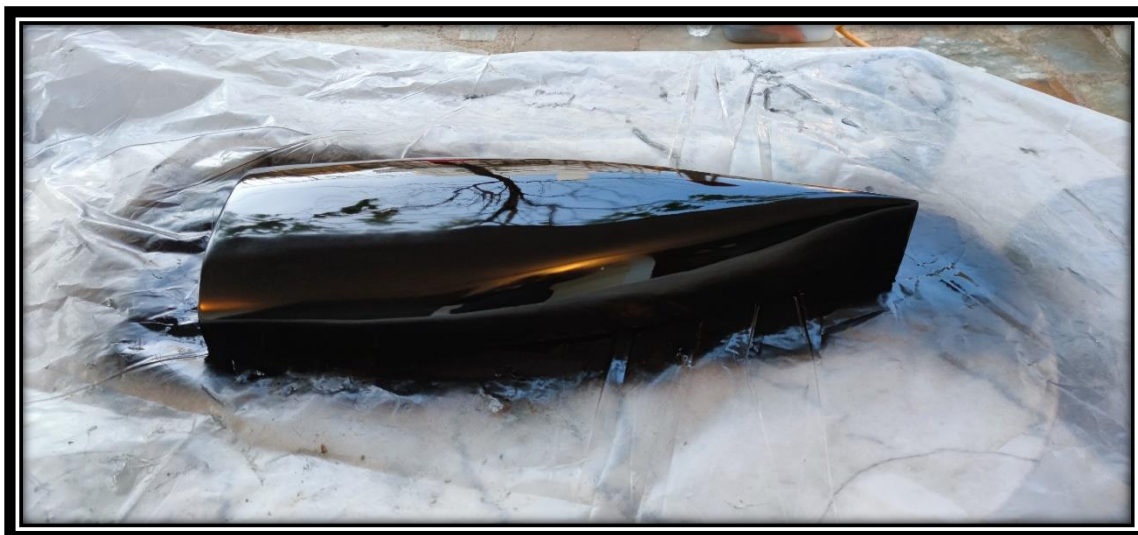
Εικόνα 3.3-40: Ολοκλήρωση τρίτης φάσης λείανσης.
