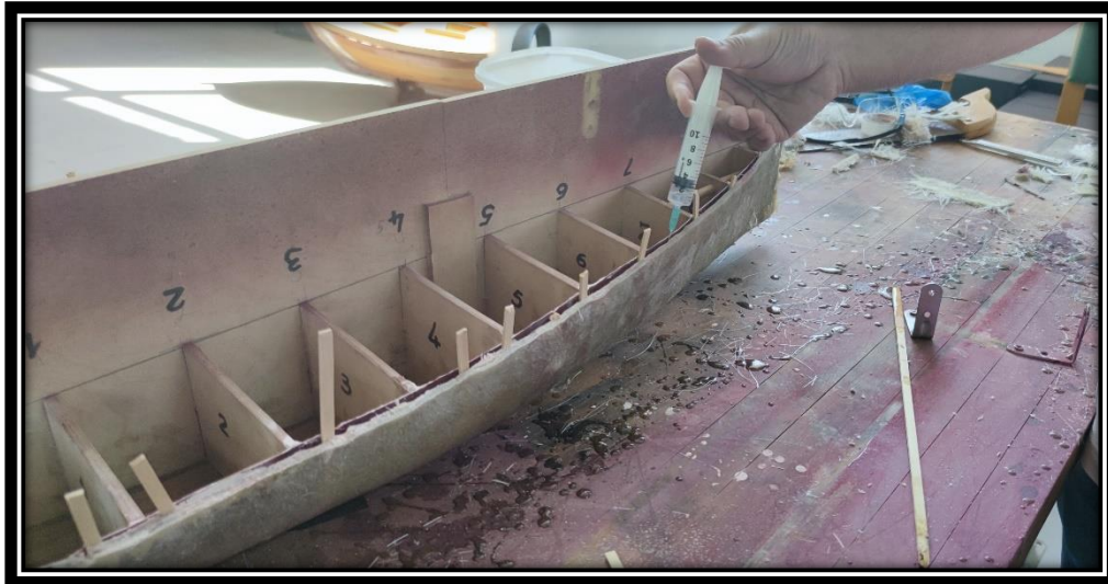
Εικόνα 3.2-14: Εγχύσεις ακετόνης κατά τη διαδικασία της αποκόλλησης.
