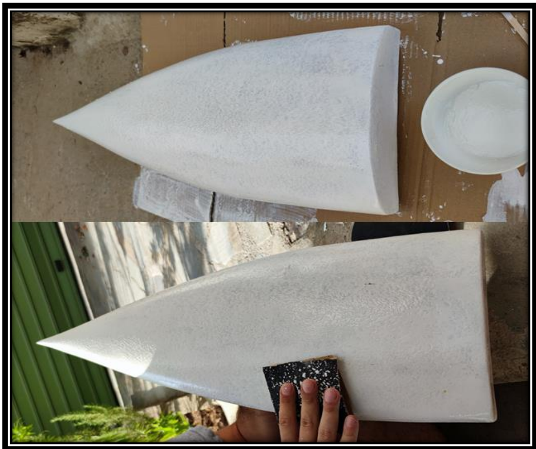
Εικόνα 3.3-27: Διαδικασία εφαρμογής και απόξεσης Gel Coat.
