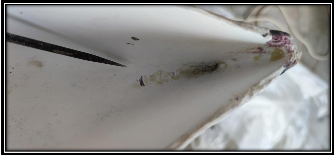
Εικόνα 3.3-19: Απεικόνιση του τραυματισμού του καλουπιού.
