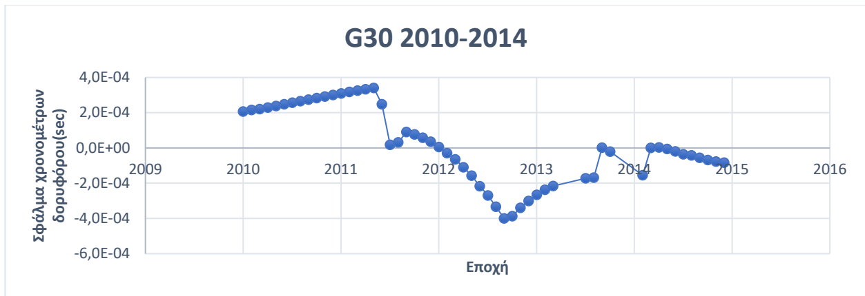
Διάγραμμα 4-46: Πορεία σφάλματος χρονομέτρων δορυφόρου G30 για την περίοδο 2010-2014 (Block IIF από 11/02/2014 έως σήμερα).
