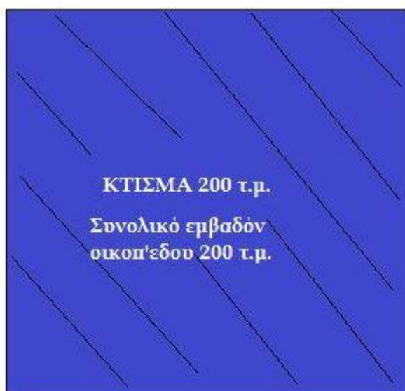
β. Παράνομο κτίσμα: Υπερβαίνει την επιτρεπόμενη επιφάνεια κάλυψης ( 100 τ.μ. )
