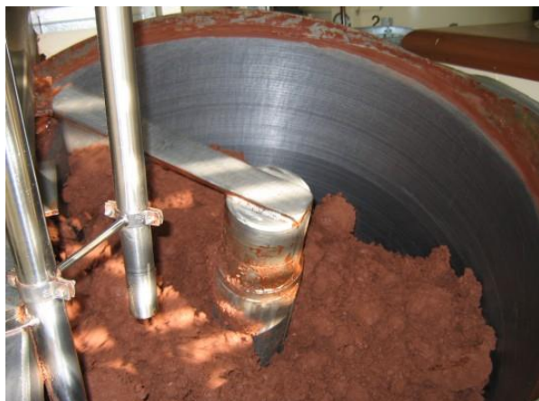
Εικόνα 46: Πρώτη ή ξηρή φάση κονσαρίσματος (Πηγή: https://blog.equalexchange.coop/organic-cacao-bean-bar/chocolate-is-agitated-within-a-conching-machine/ )
