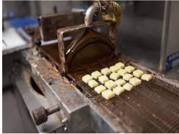
Εικόνα 56: Δια χειρός επικάλυψη σε σοκολατάκια ( Πηγή: https://www.cacao-barry.com/en-US/chocolate-technique ) Εικόνα 57: Επικάλυψη χρήσει «καταρράκτη» καταιωνισμού σοκολάτας ( Πηγή: https://in-confectionery.com/new-technology-enhances-chocolate-production/ )
