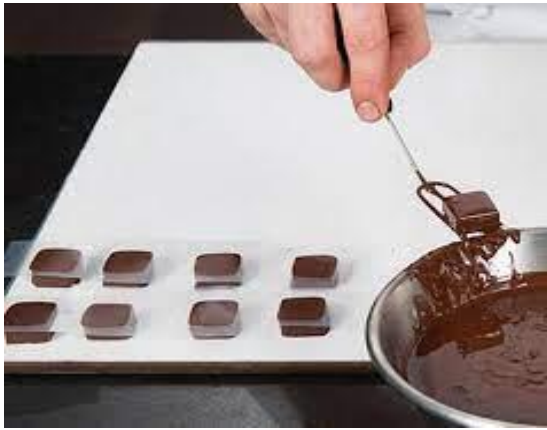
Εικόνα 56: Δια χειρός επικάλυψη σε σοκολατάκια ( Πηγή: https://www.cacao-barry.com/en-US/chocolate-technique ) Εικόνα 57: Επικάλυψη χρήσει «καταρράκτη» καταιωνισμού σοκολάτας ( Πηγή: https://in-confectionery.com/new-technology-enhances-chocolate-production/ )
