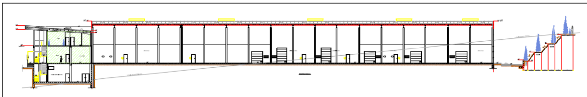
Σχήμα 3.2: Θερμαινόμενοι χώροι του κτηρίου.
