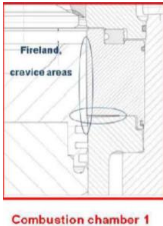
Εικόνα 17: Σημεία συσσώρευσης άκαυστου μείγματος στον κύλινδρο.[12]
