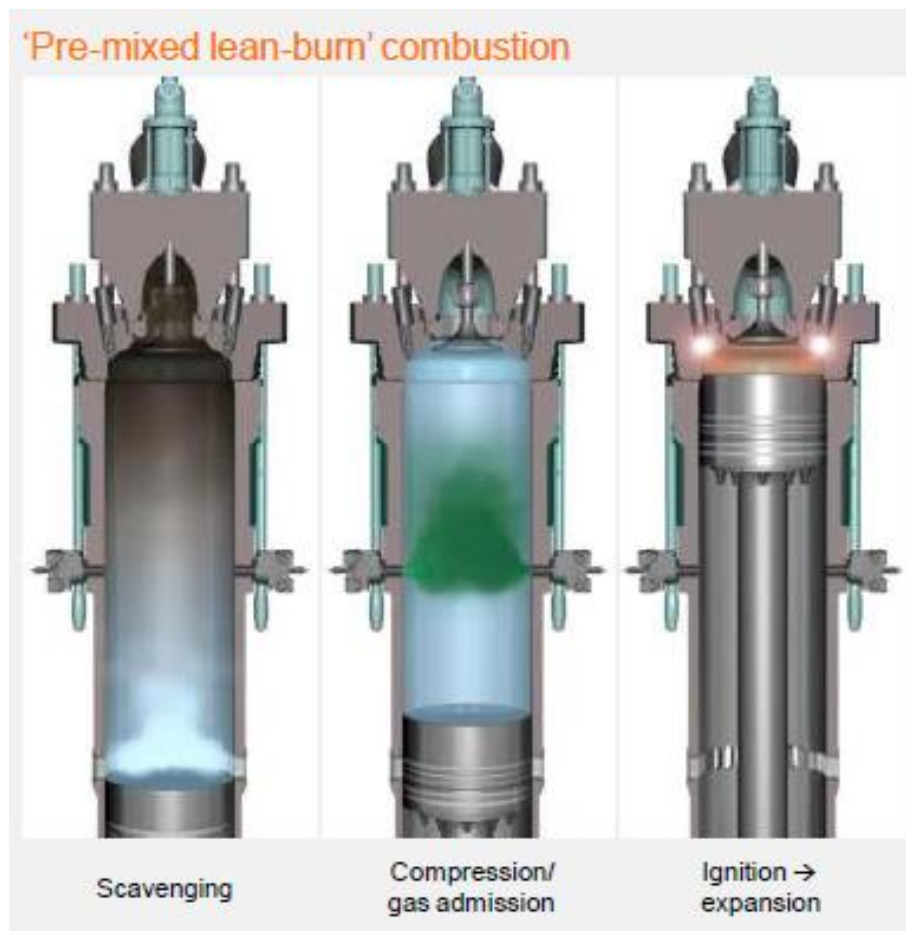
Εικόνα 6: Καύση προαναμεμιγμένου φτωχού καυσίμου σε μεγάλο ναυτικό κινητήρα. [12]
