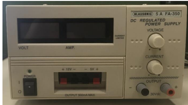
Εικόνα 6.6. Τροφοδοτικό συνεχούς ρεύματος BLAUSONIC FA-350
