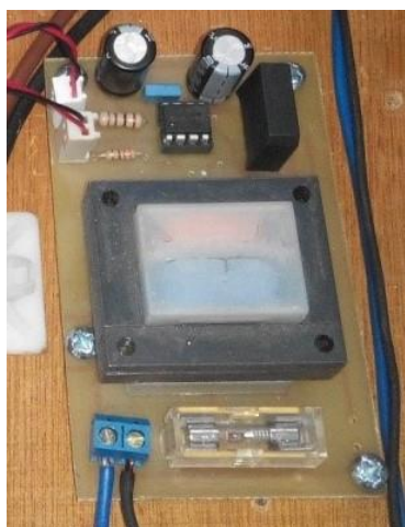
Εικόνα 2.3. Φωτογραφία κυκλώματος οδήγησης MOSFET. (Πηγή: (Γεώργιος X. Ιωαννίδης, 2015))
