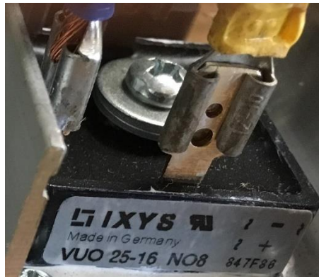
Εικόνα 2.1. Τριφασική γέφυρά με διόδους.
