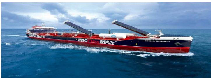
Εικόνα 12: Το Σχέδιο ενός Υβριδικού - Πράσινου Πλοίου με Κυλινδρικά Ιστία, Ηλιακά Πάνελ και Κινητήρες LNG. Πηγή: www.naftikachronika.gr
